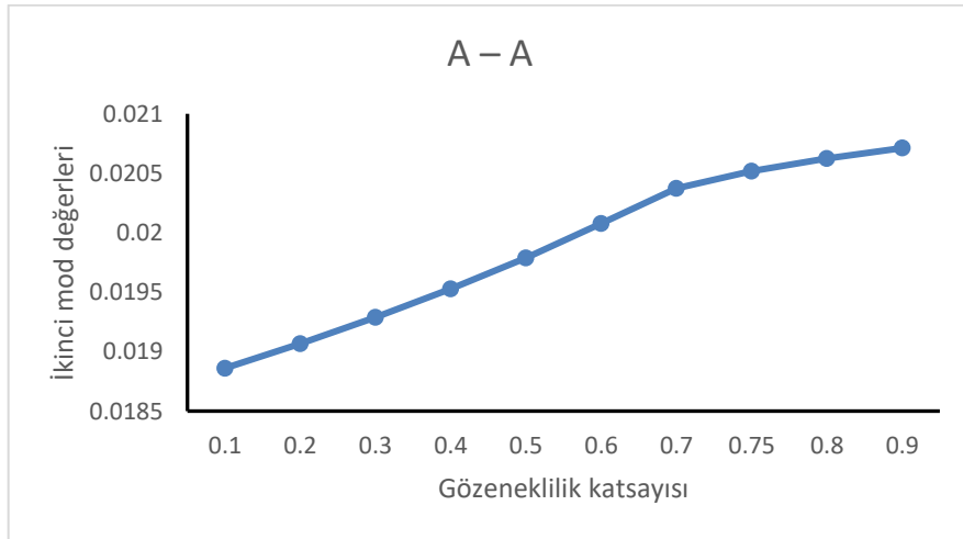
Şekil 73. Ankastre – Ankastre mesnetli FD sandviç çubuğunun farklı e_0 değerleri için 2. Mod genliklerinin karşılaştırılması
