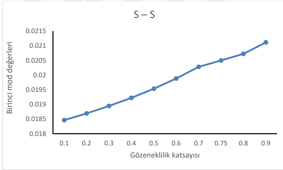
Şekil 67. Sabit – Sabit mesentli FD sandviç çubuğunun farklı e_0 değerleri için 1. Mod genliklerinin karşılaştırılması
