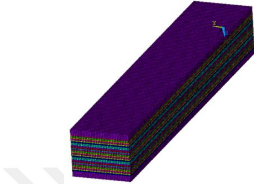
Şekil 12. Simetrik gözenekli çekirdeğe sahip FD sandviç kiriş için sonlu eleman modeli (SMCR)
