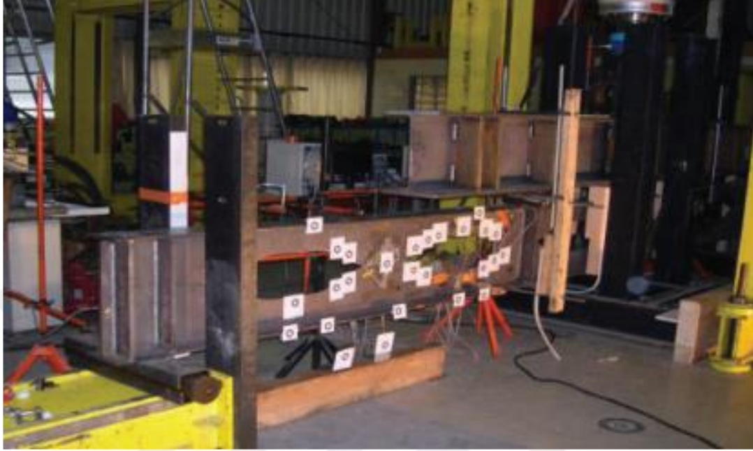
Şekil 8. Sinüzoidal boşluklu petek kiriş numunesi (Durif ve Bouchair, 2012)
