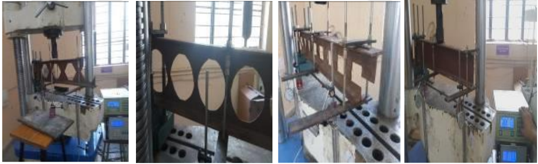
Şekil 13. Petek kirilerin deney düzeneği (Shaikh ve Autade, 2016)
