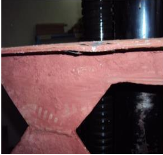
Şekil 12. Petek kiriş deneyi (Wakchaure ve Sagade, 2012a)
