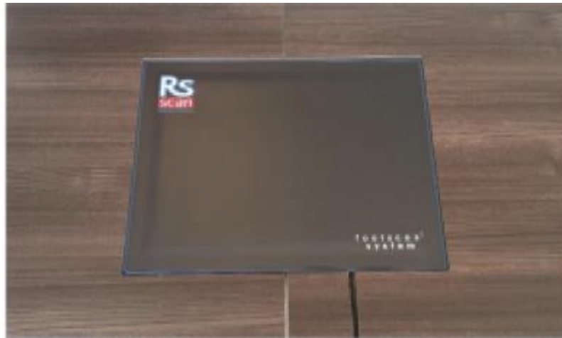
Şekil 10. Statik Pedobarografik Analiz cihazının görüntüsü (Ledoux, 2023).
