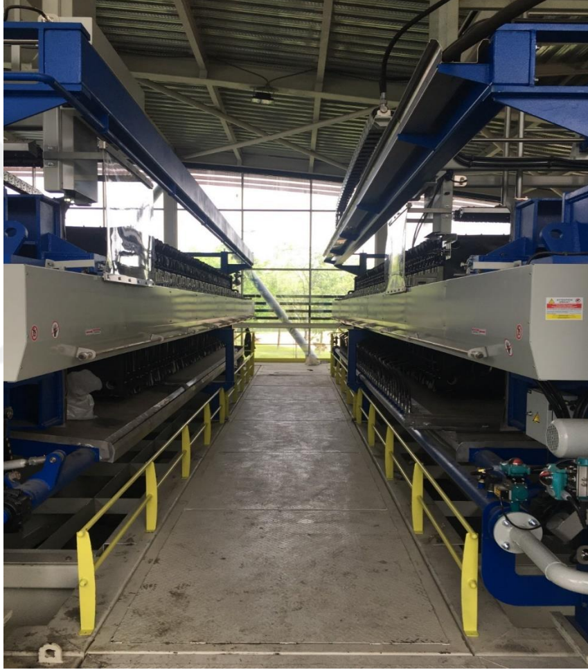
řekil 19. Susuzlařtırma İřlemine yapacak olan Filtrepres sistemi
