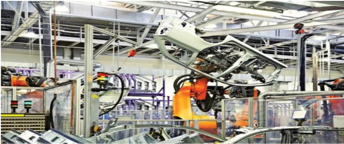
Şekil 4. Araba gövde parçalarının robotize montajı
