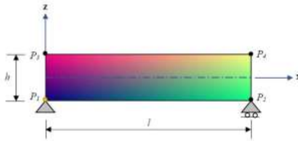
Şekil 1. Malzeme özelliklerinin kiriş boyunca çift yönlü değişimi
