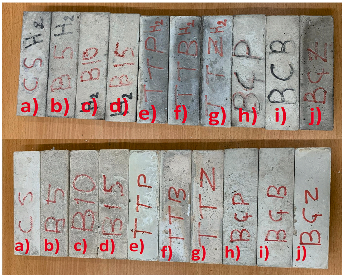
Fig. 14. Visual inspection after 750 °C: a) WC, b) CBP5, c) CBP10, d) CBP15, e) CBP5CC, f) CBP5B, g) CBP5C, h) WCC, i) WCB, j) WCC.
