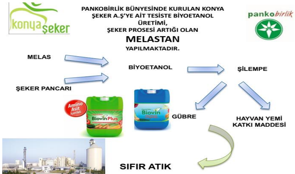
Şekil 12. Şeker pancarından biyoetanol üretiminde sıfır atık döngüsü
