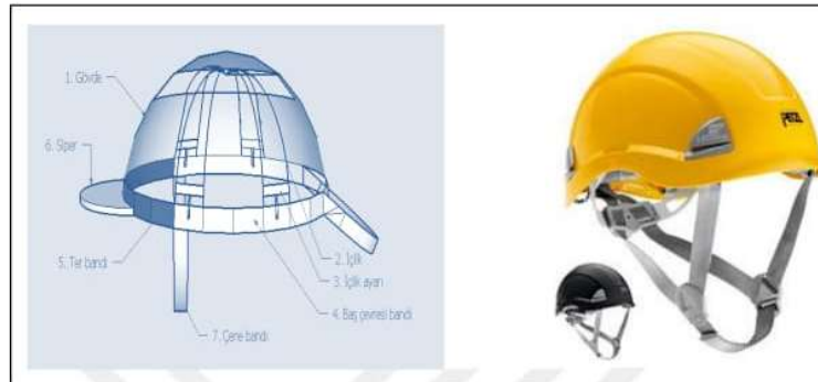
Şekil 32 Endüstriyel baretin bölümleri ve kask örneği
