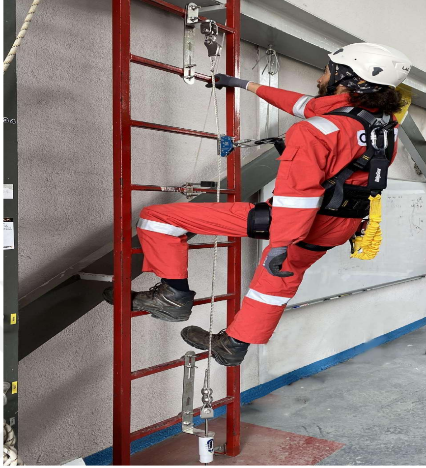
Şekil 22 EN 353-1 Düşmeyi Önleyen Frenleme Sistemi (Dikey Hat Üzerinde)
