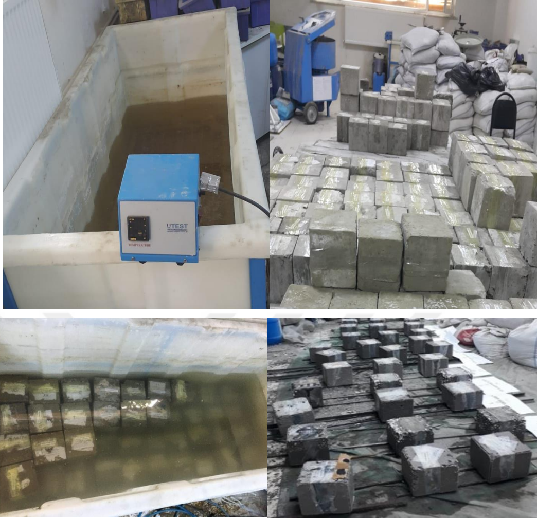
Şekil3. 9. Beton küp örneklerinin %3,5 NaCl çözeltilerinde bekletilmesi ve çıkarılması
