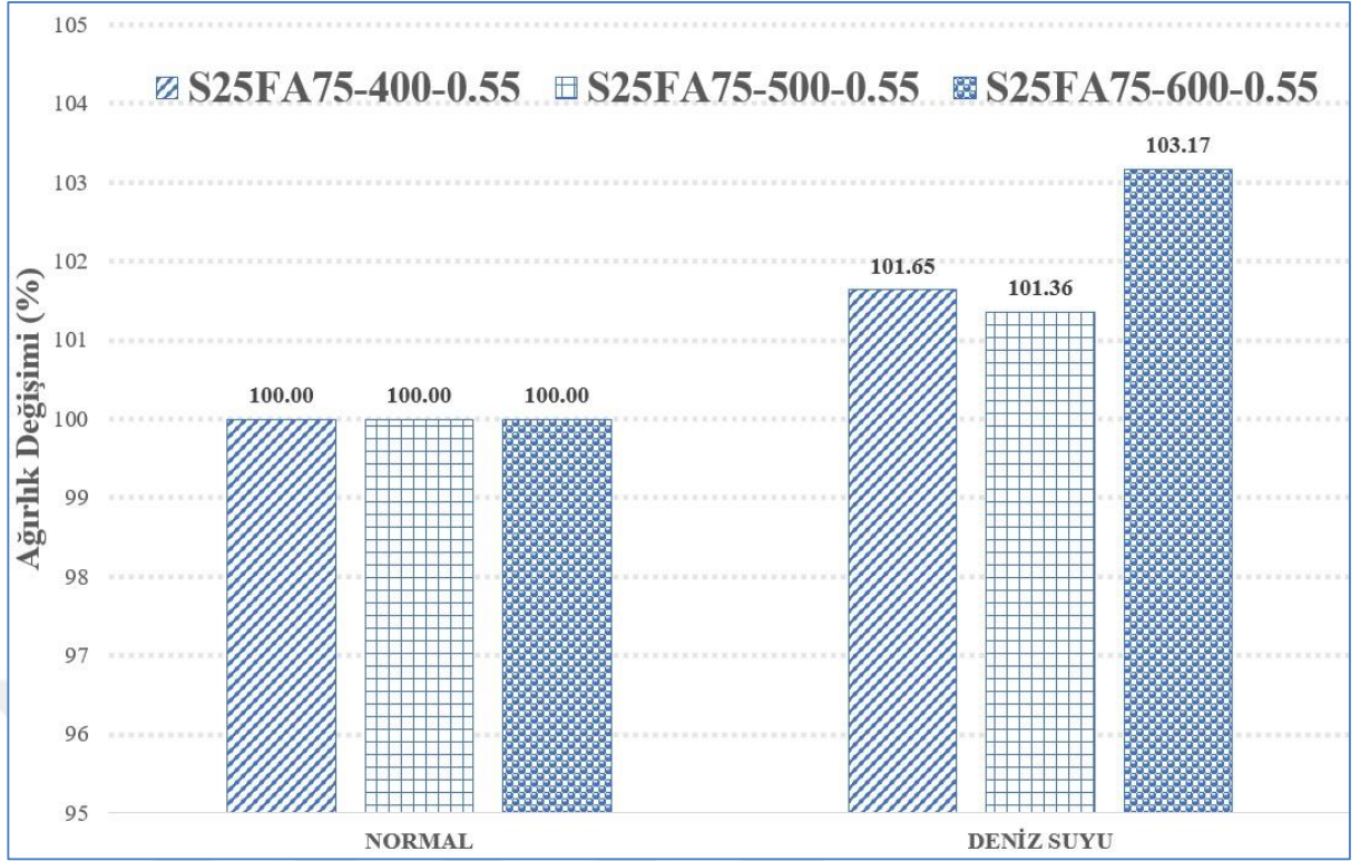
Şekil4. 5. S25FA75-400-0,55, S25FA75-500-0,55 ve S25FA75-600-0,55 numunelerinin ağırlık değişimi sonuçları
