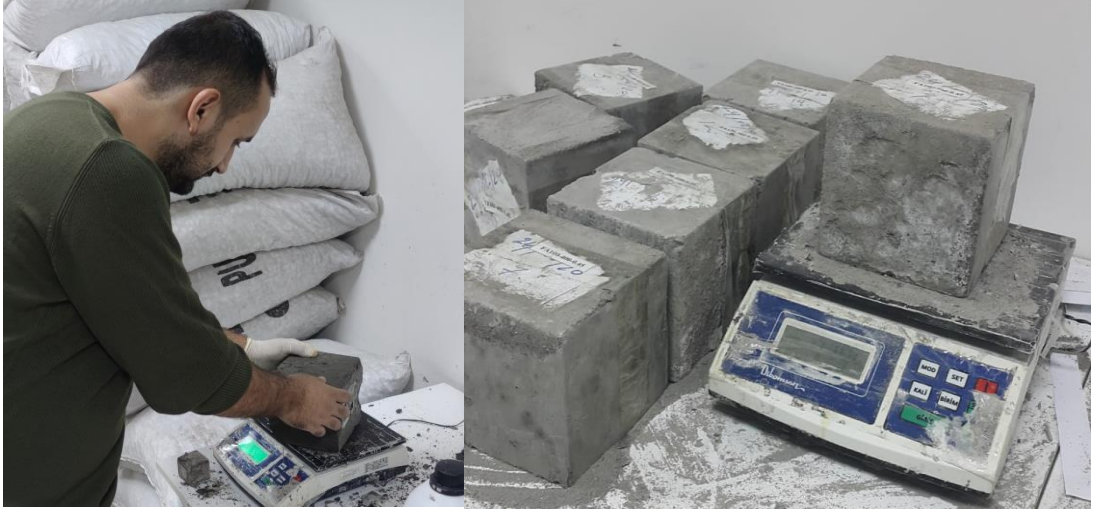
Şekil3. 10. Geopolimer küp örneklerinin ağırlığının ölçümü
