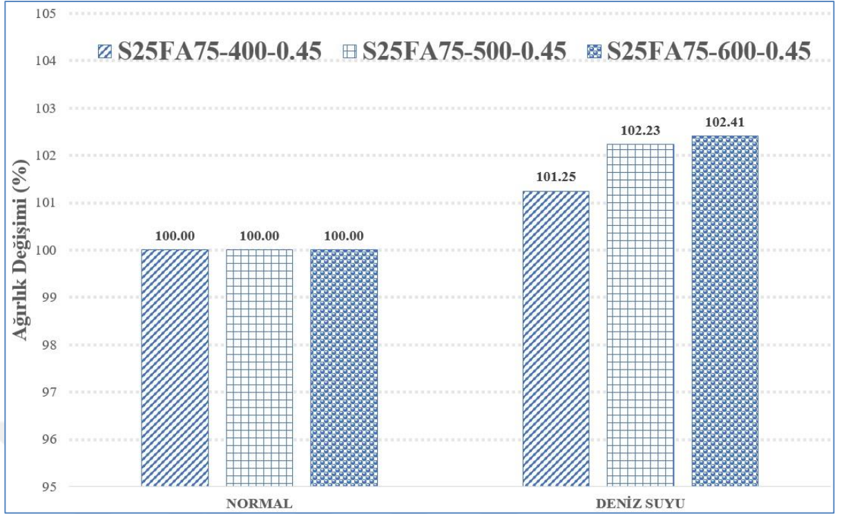
Şekil4. 4. S25FA75-400-0,45, S25FA75-500-0,45 ve S25FA75-600-0,45 numunelerinin ağırlık değişimi sonuçları
