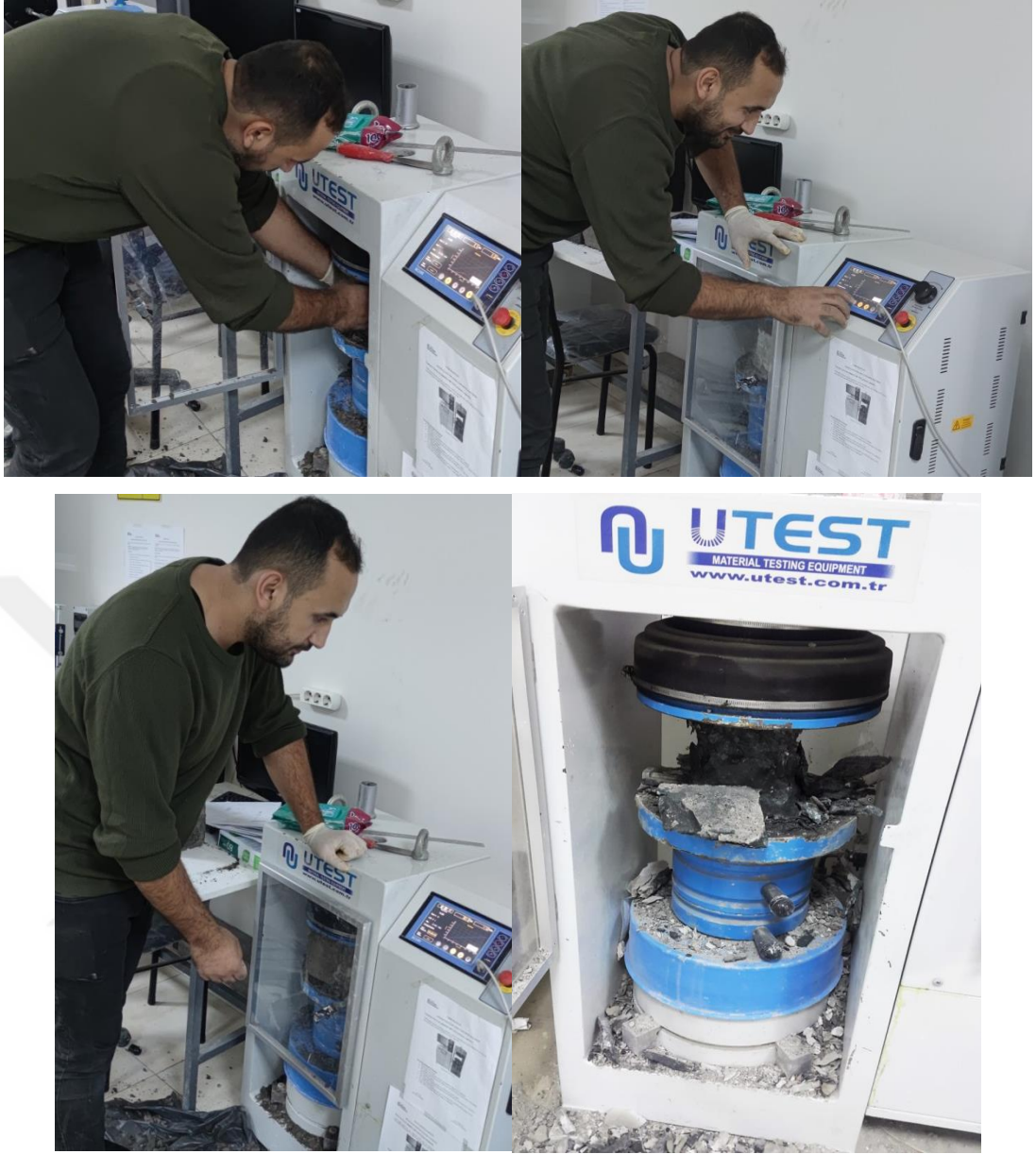
Şekil3. 11. Geopolimer küp beton örneklerinin basınç mukavemetlerinin ölçümü
