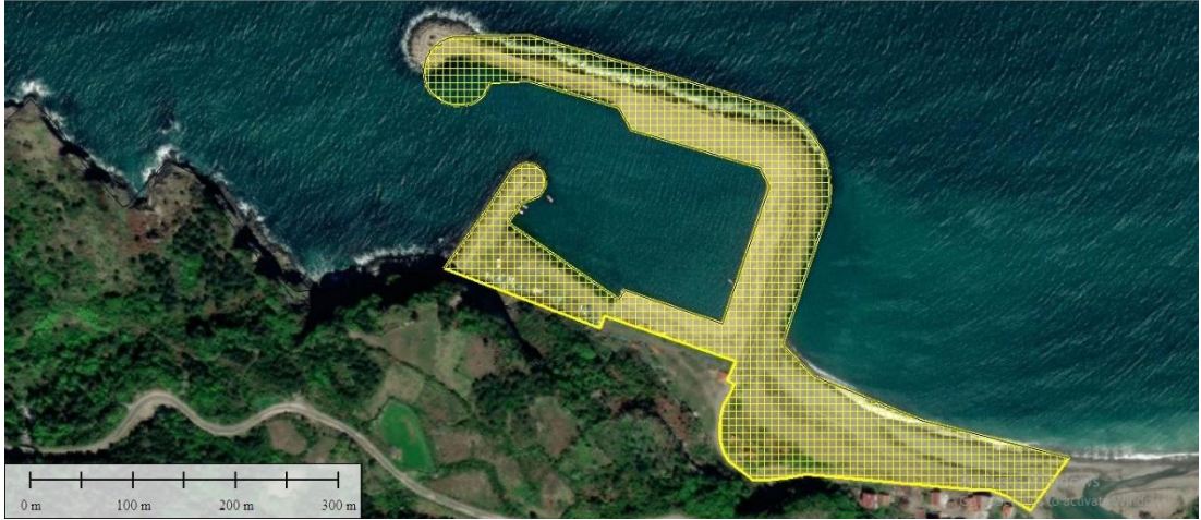
Şekil 9. Birinci tasarım (ana dalgakıran uzunluğu yaklaşık 20 m).
