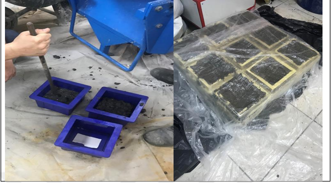
Şekil 3. 8. Beton üretim aşamaları
