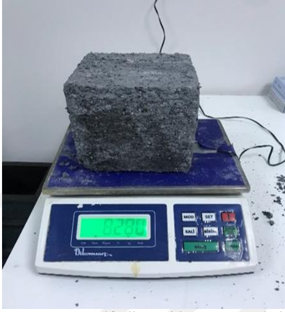
Şekil 3.10. Sülfürik aside maruz kalan beton numunelerinin ağırlıklarının belirlenmesi
