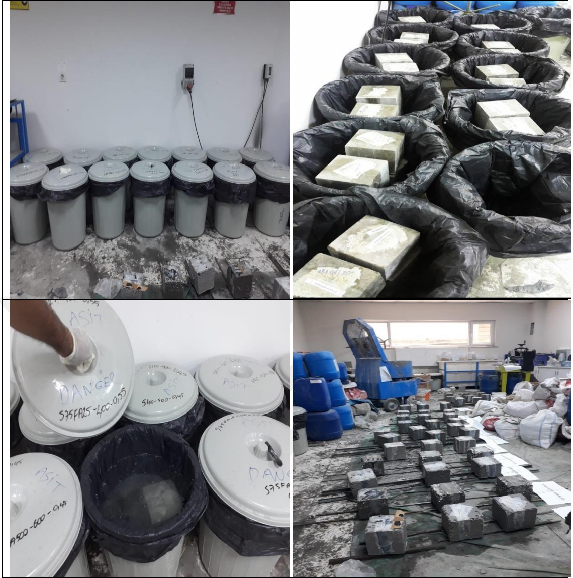
Şekil 3. 9. Numunelerimizin sülfürik asit solüsyonunda bekletilme ile çıkarılma işlemleri
