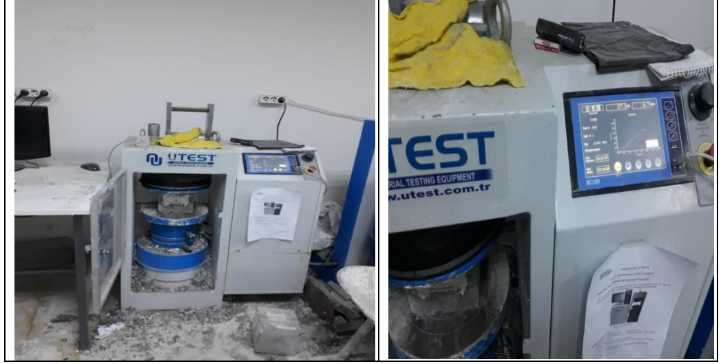
Şekil 3. 11. Küp numunelerin basınç testlerinin yapılması
