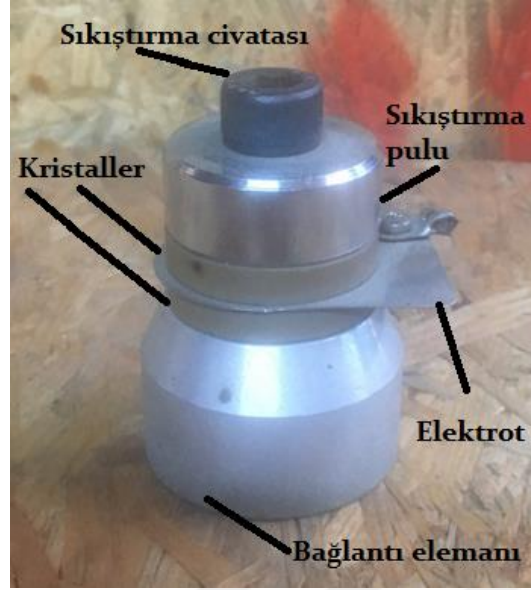
Şekil 6.12. Transdüseri oluşturan elemanların montajı
