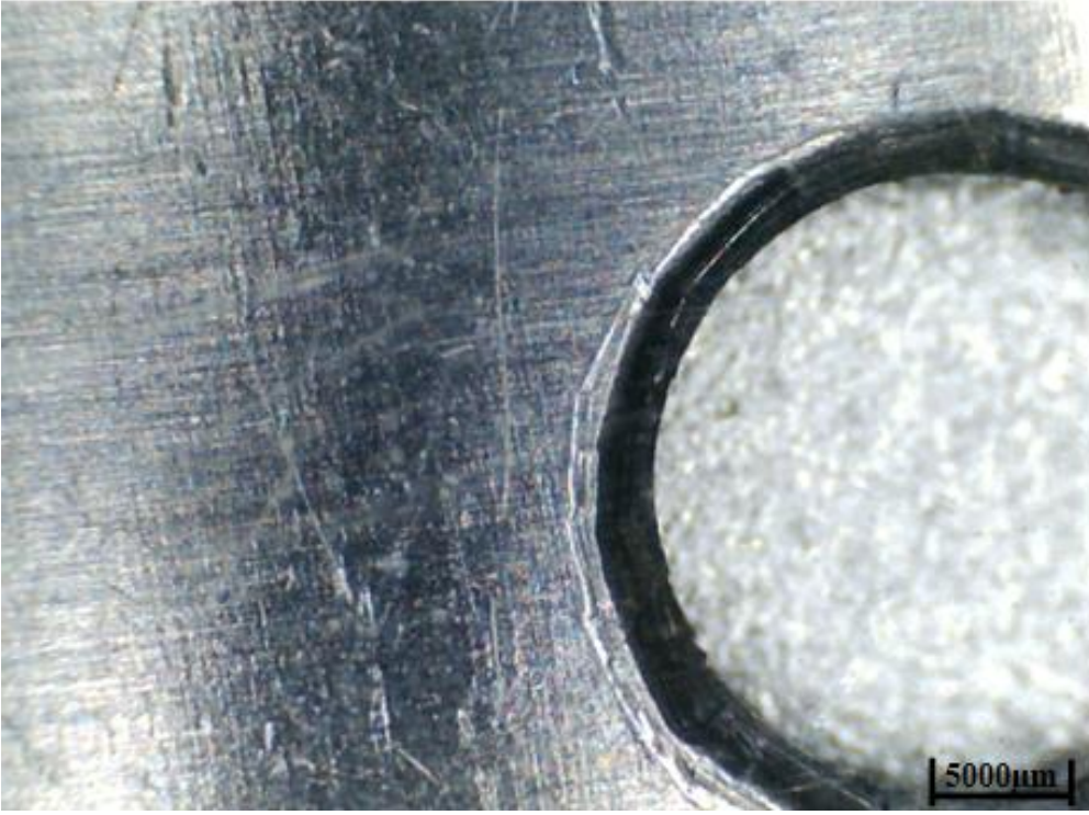
Şekil 7.22. Paslanmaz sac montaj parçasının parçasının 3 dakika 60°C ultrasonik temizleme yapılmasından sonra 20X büyüme ile 5000µm skalasında mikroskop görüntüsü
