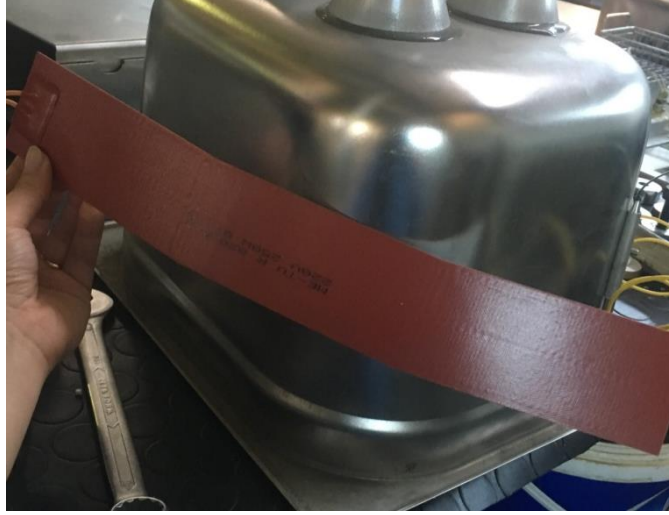
Şekil 6.20. Temizleme tankına ısıtıcı bant rezistansın montajı
