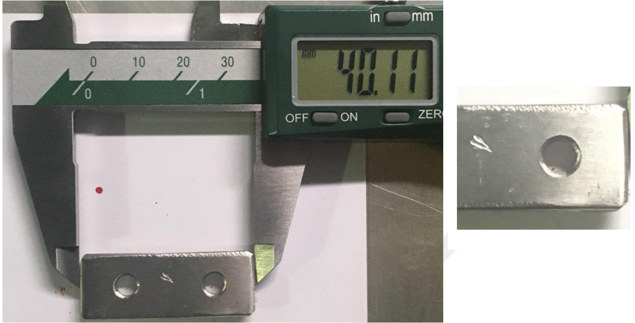
Şekil 7.18. Boyutu 40.11 mm olan paslanmaz sactan yapılan montaj parçasının üzerindeki çizikler ve ezilmeler
