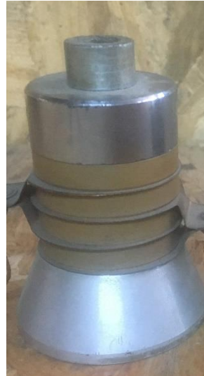
Şekil 6.13. Dört kristalli transdüser montajı
