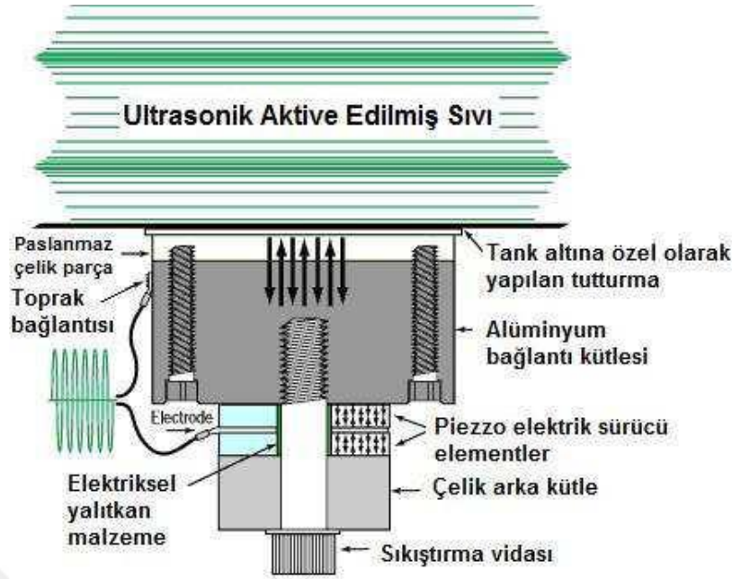
Şekil 5.2. Piezoelektrik dönüştürücünün yapısı ve montajı [6]
