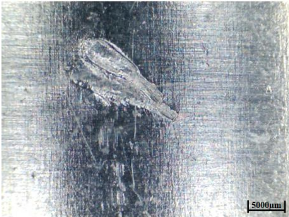
Şekil 7.21. Paslanmaz sac montaj parçasının parçasının 3 dakika 60°C ultrasonik temizleme yapılmasından sonra 20X büyüme ile 5000µm skalasında mikroskop görüntüsü
