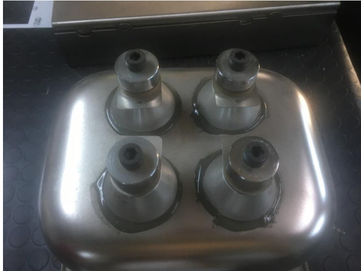
Şekil 6.16. Ultrasonik temizleme yapılacak tankın alt görünüşü ve epoksi ile transdüser montajı
