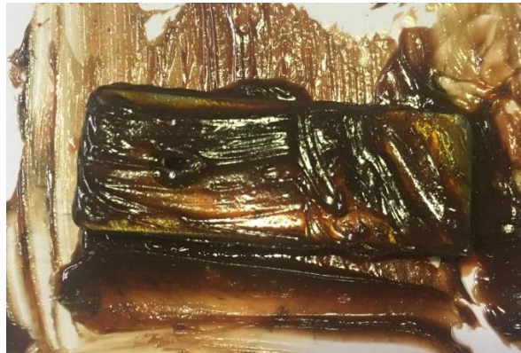
Şekil 7.19. Boyutu 40.11mm olan paslanmaz sactan yapılan montaj parçasının gres yağı ile kaplanması
