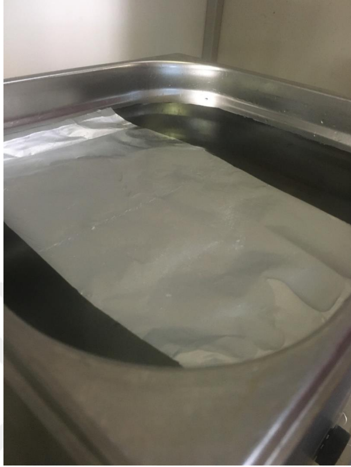
Şekil 7.1. Ultrasonik temizleme tankı içerisine koyulan su ile folyo testinin gerçekleştirilmesi
