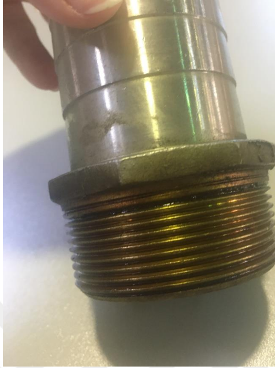
Şekil 7.9. Ultrasonik temizleme tankına girmeden önce gres yağı kalıntılarının bulunduğu kirli metal malzeme
