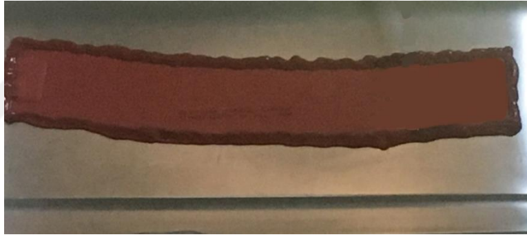
Şekil 6.21. Bant rezistansın ultrasonik temizleme yapılacak tank üzerine sabitlenmesi
