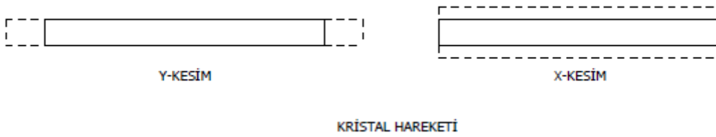
Şekil 4.6. Kristalin kesim yönüne göre hareketi [13]
