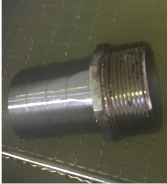
Şekil 7.10. Ultrasonik tank içerisine yerleştirilen tel sepet yardımıyla temizlenen metal malzeme
