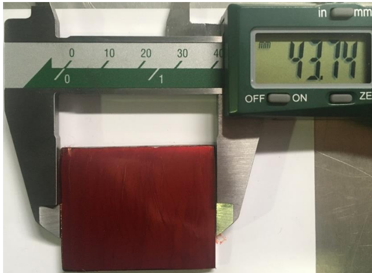
Şekil 7.15. Boyutu 43.74 mm olan çizilmiş paslanmaz sacın markalama boyası ile kaplanması
