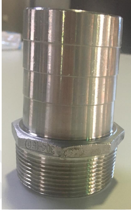
Şekil 7.11. 60°C sıcaklıkta 3 dakika boyunca ultrasonik temizlik yapılan gres yağı kalıntılarında arındırılmış metal malzeme yüzey görünümü
