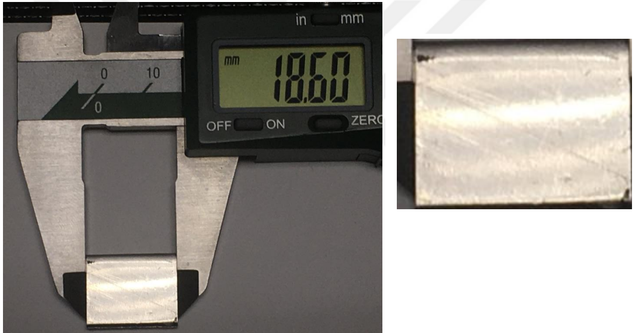
Şekil 7.12. Boyutu 18.60mm olan paslanmaz sacın üzerindeki çizikler ve ezilmeler
