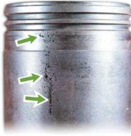
Şekil 3.3. Kavitasyon erozyonunun metal malzeme üzerindeki etkisi
