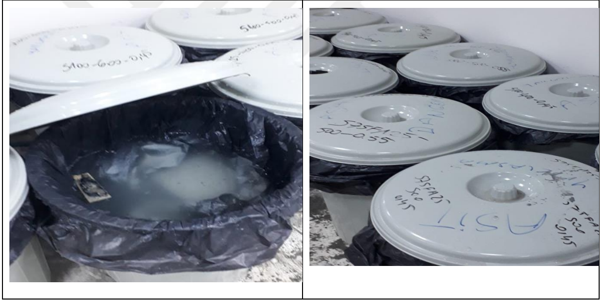
Őekil 3.7. Numunelerin %5 Slfrik Asit zeltisinde Bekletilmesi
