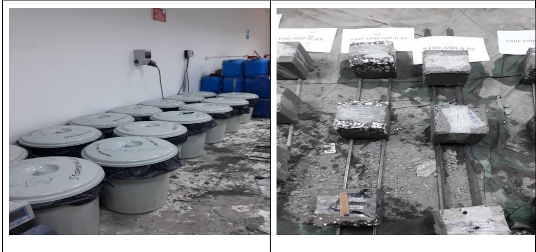
Şekil 3.7. Numunelerin %5 sülfürik asit çözeltisinde tutulması ve çıkarılması
