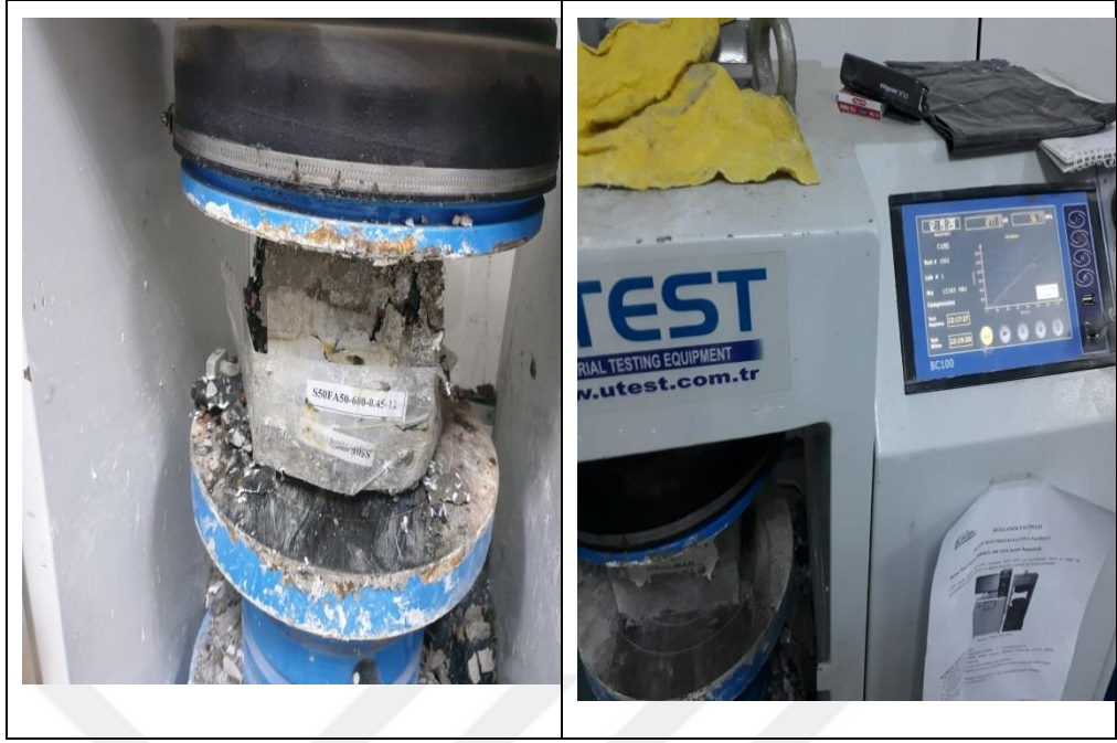
Şekil 3.9. Küp numunelerin basınç testlerinin yapılması
