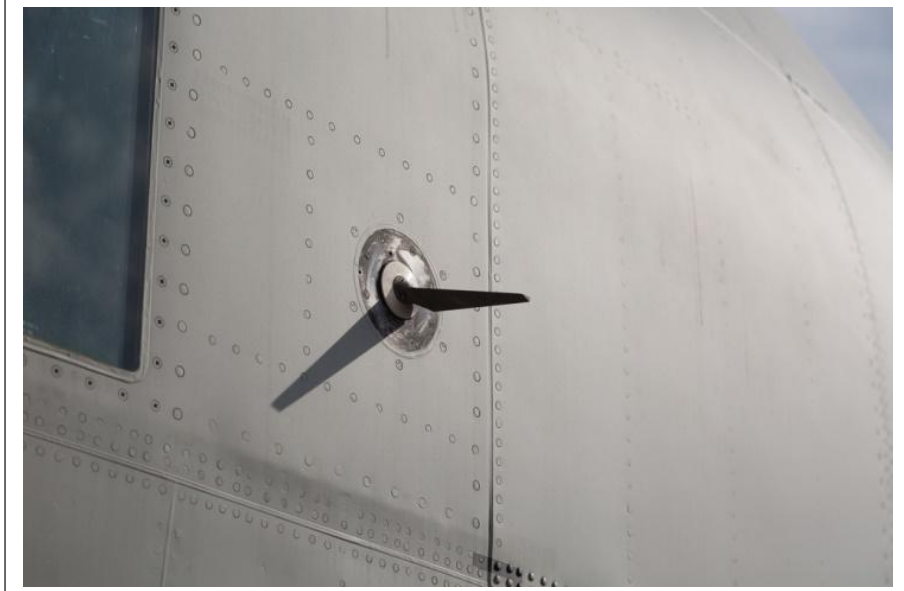
Şekil 3. Uçağın Her İki Tarafında Bulunan AoA Sensörü
