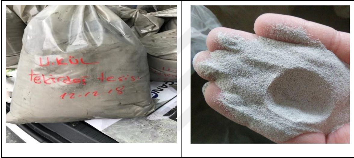
Şekil 3.2 Çalışmada kullandığımız F-tip uçucu kül
