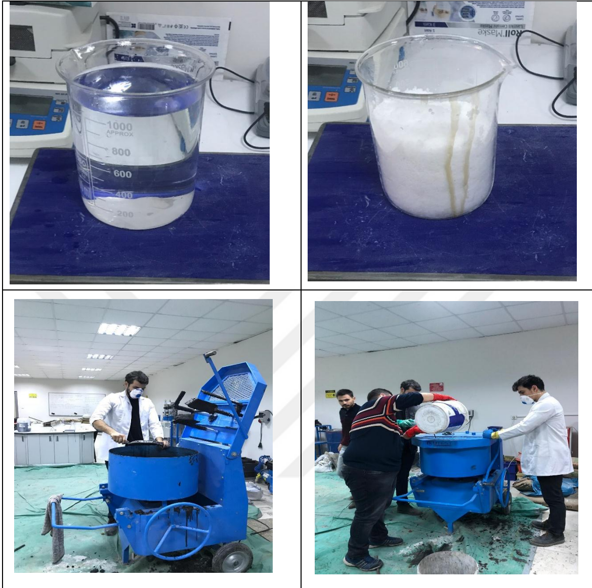
Şekil 3.8 Alkali aktivatörlerin hazırlanma aşaması ve uygulamaları
