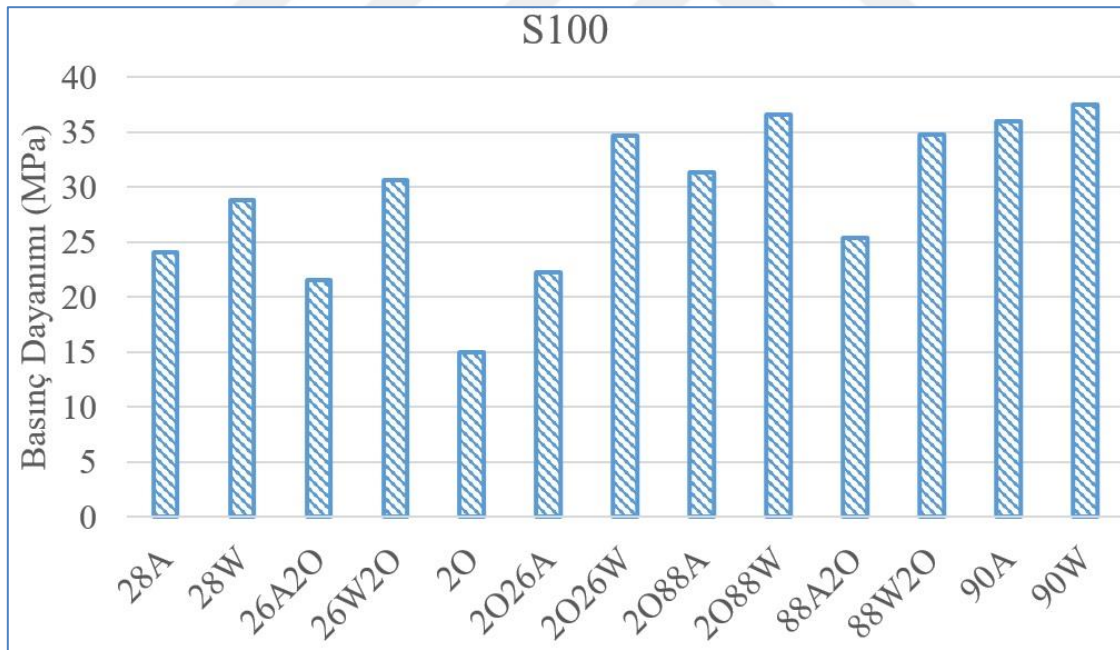
Şekil 4.3. S100 numunelerinin 28. ve 90. günlerdeki basınç dayanımlarının değişimi
