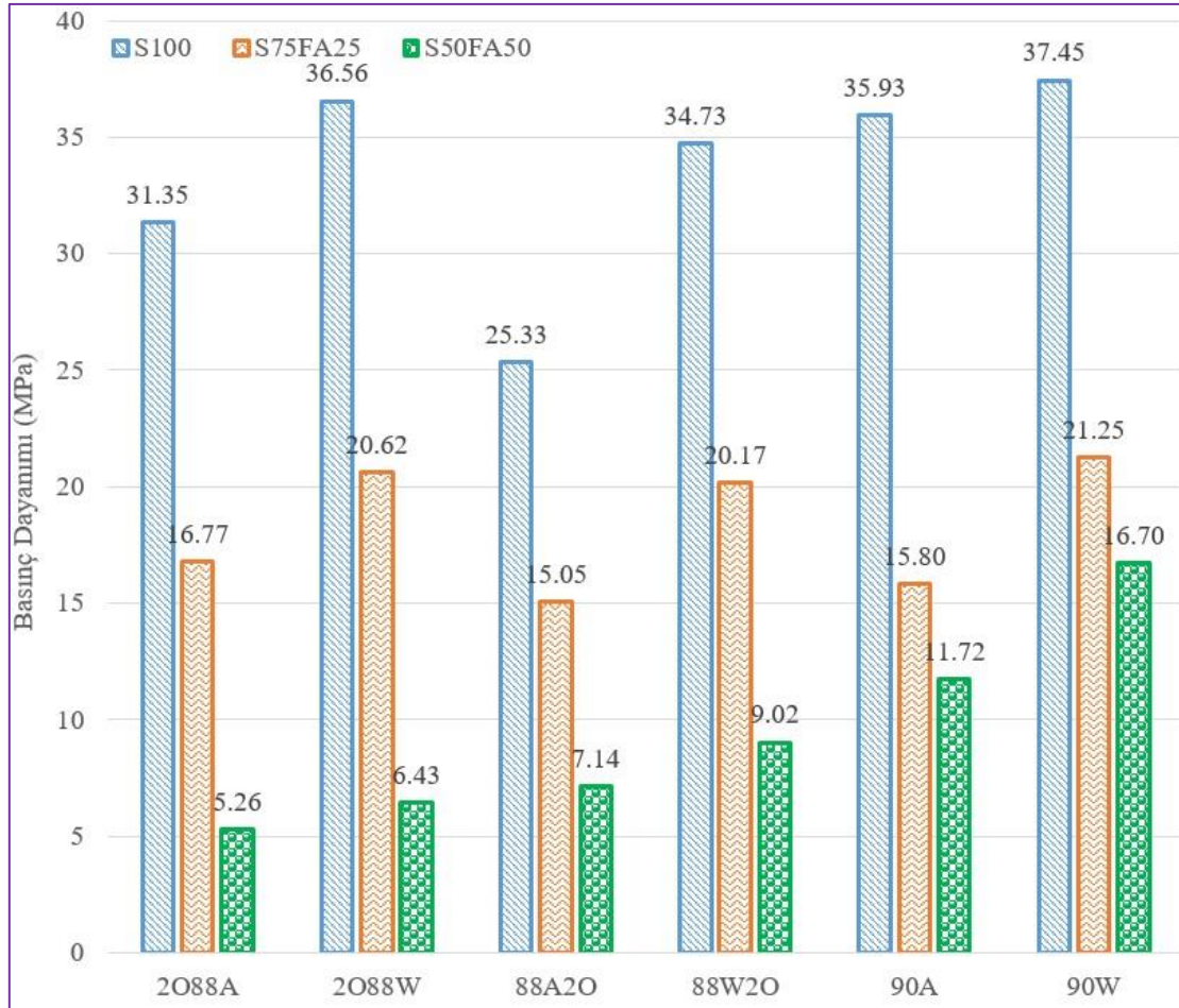
Şekil 4.11. Farklı geopolimer numunelerin 90. gündeki basınç dayanımlarının değişimi
