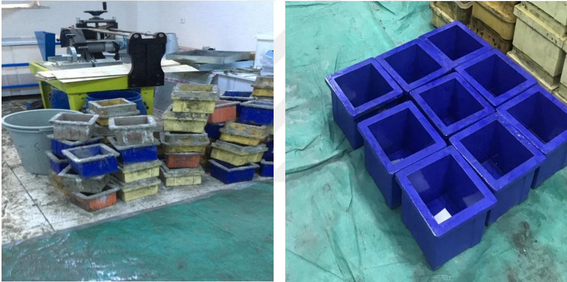
Şekil 3.5. Uygulamada kullanılan küp numuneler
