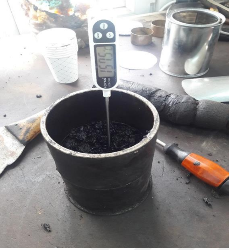
Şekil 3.11. Sıkıştırma işlemi için uygun sıcaklığın (145 °C) beklenmesi
