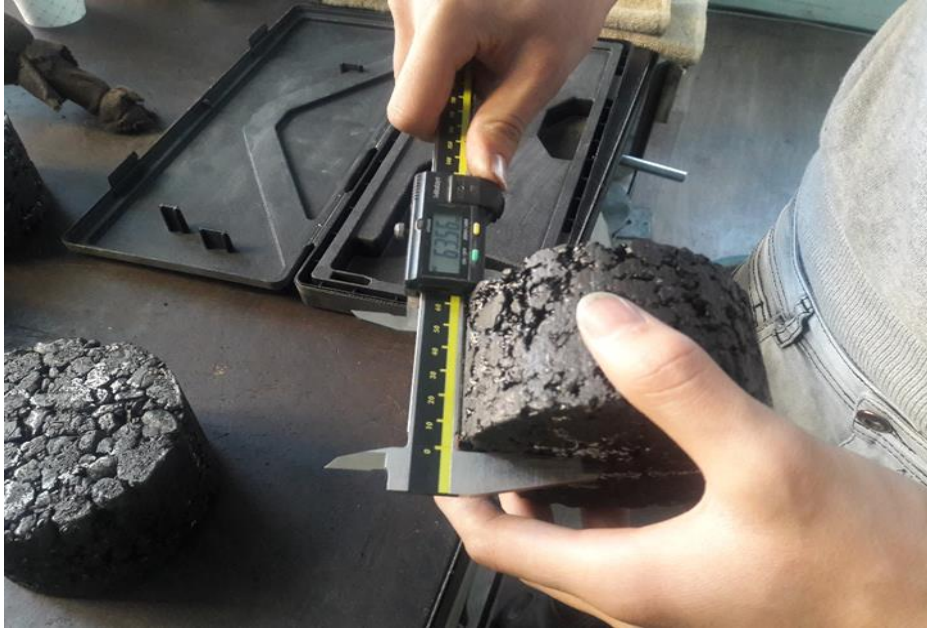
Şekil 3.14. Marshall briketlerinin yüksekliğinin ölçülmesi
