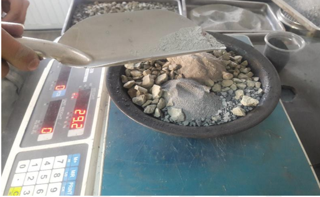
Şekil 3.7. Malzemelerin belirtilen miktarlarda tartılması
