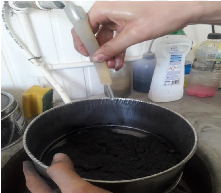
Şekil 3.3. Grafit malzemesinin elek analizi için yıkanması
