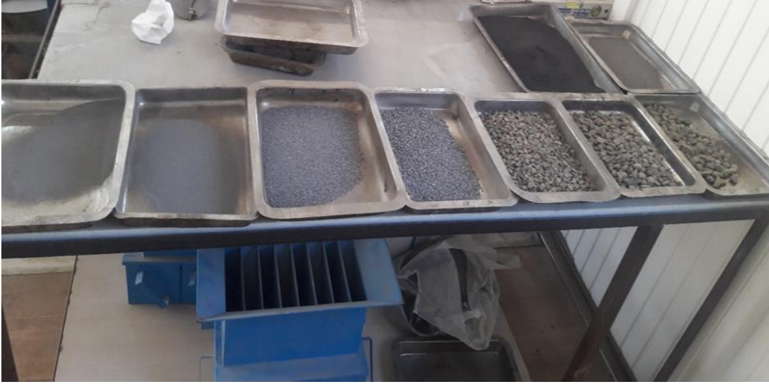
Şekil 3.2. Agregaların elle eleme yöntemiyle dane boyutlarına göre ayrılması
