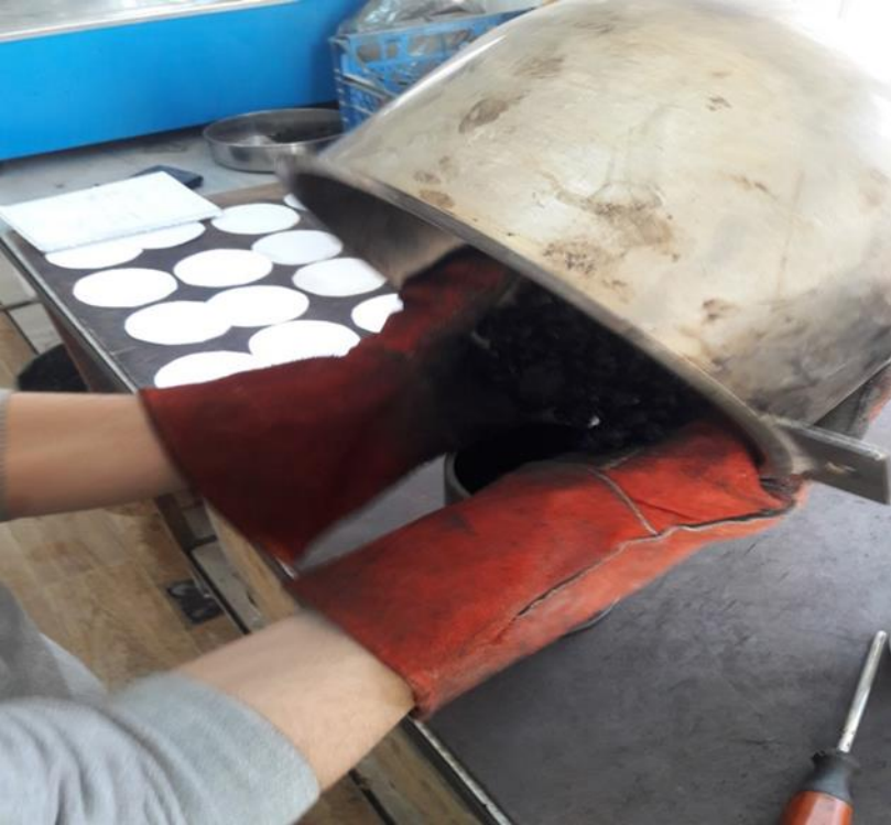
Şekil 3.10. Karışımın Marshall briket kalıplarına dökülmesi
