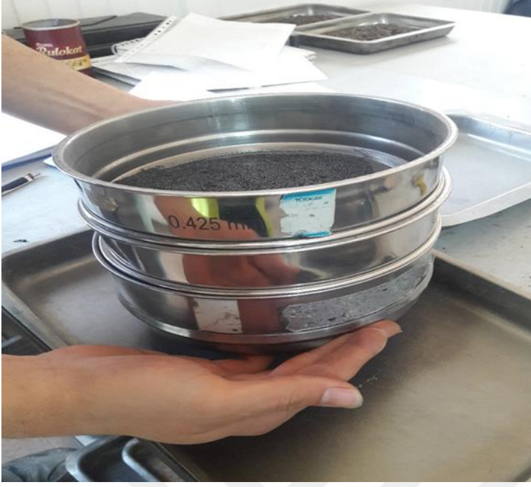
Şekil 3.6. Grafit malzemesinin elek analizi
