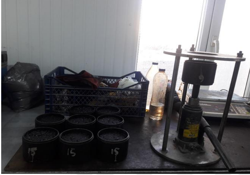
Şekil 3.13. Marshall briketlerinin kalıplarından çıkartılması
