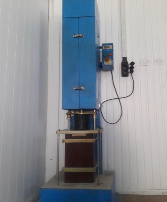
Şekil 3.12. Marshall tokmağı ile briketlerin sıkıştırılması
