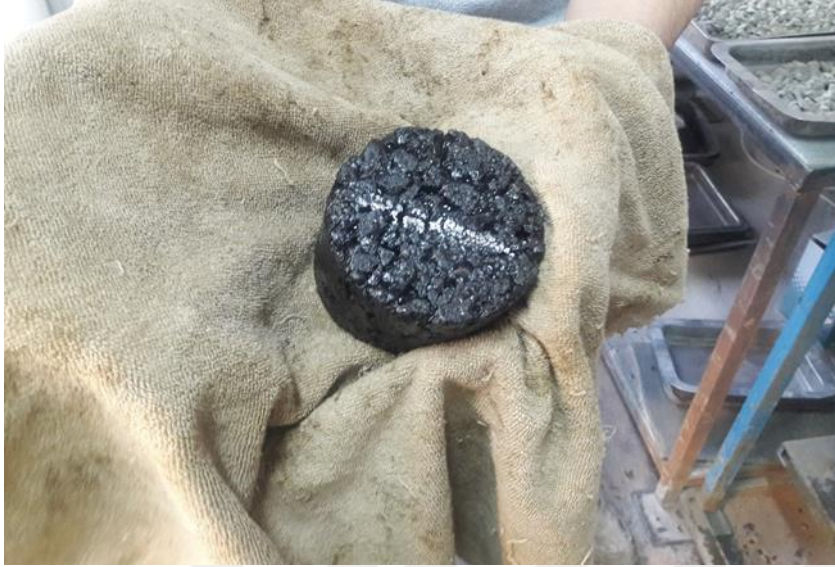
Şekil 3.17. Briketin doymun yüzey ağırlığının belirlenmesi
