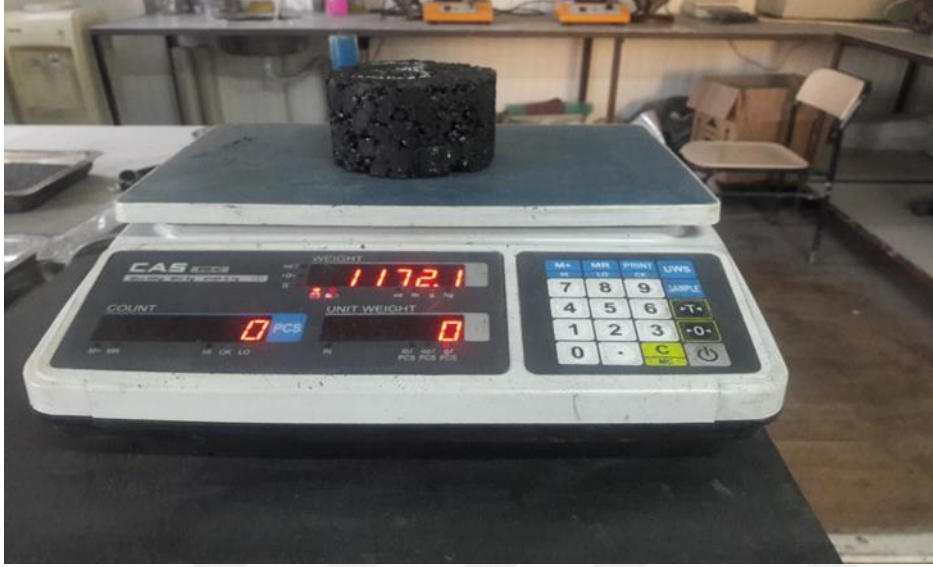
Şekil 3.15. Briketin havadaki kuru birim ağırlığının belirlenmesi
