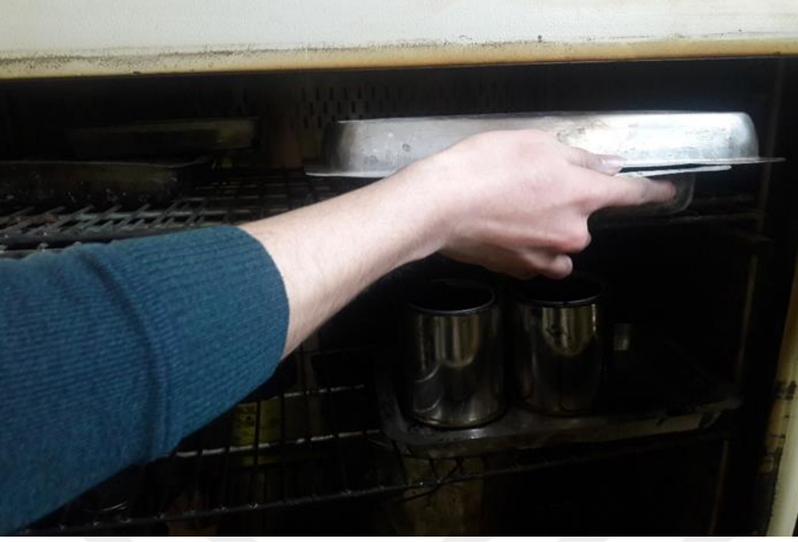
Şekil 3.4. Grafit malzemesinin etüvte kurutulması
