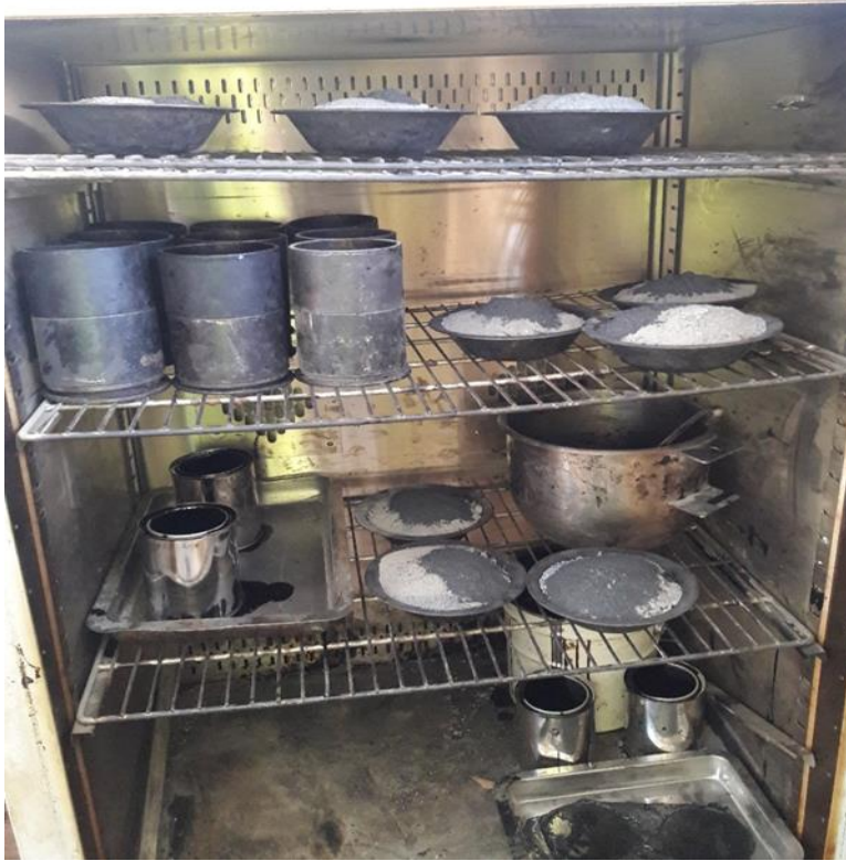
Şekil 3.8. Malzemelerin etüvde uygun sıcaklığa gelene kadar bekletilmesi
