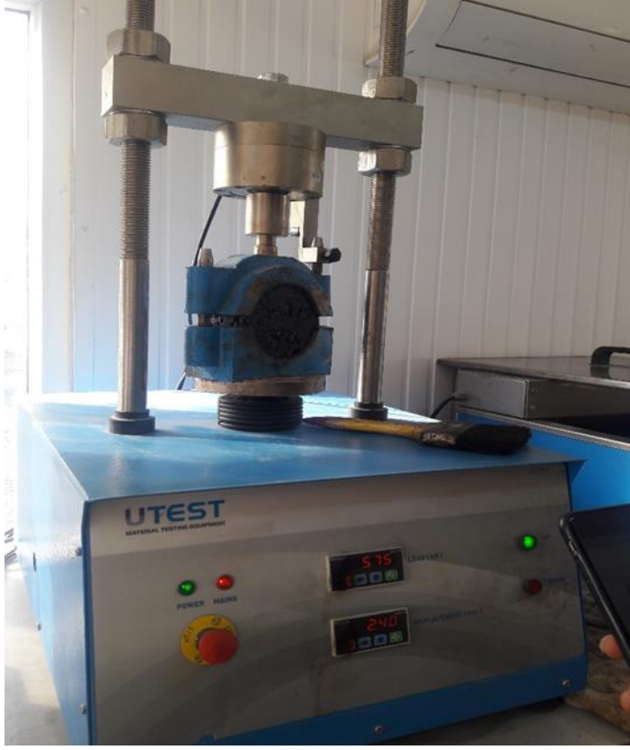
Şekil 3.18. Briketlerin akma ve stabilite deęerlerini belirlenmesi
