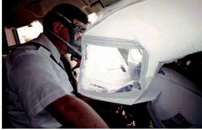
Resim -10 Duman Yer Değiştirme Sistemi “(EVAS- Geliştirilmiş Görüş Güvence Sistemi)” 59
