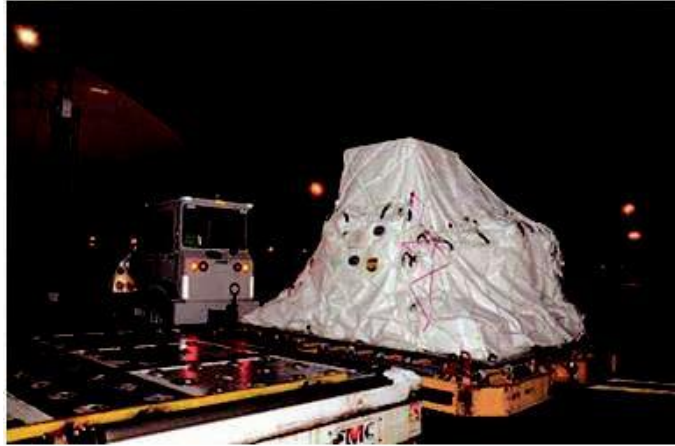
Resim-9 Yangın Söndürme Kapaklı Açık Palet 58
