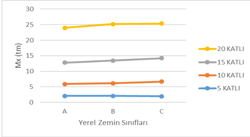
Şekil 4.62. 3. Derece deprem bölgesinde x yönünde oluşan maksimum moment değerleri
