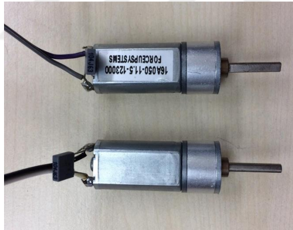
Şekil 4.47 Tez çalışmasında Kullanılan Redüktörlü DC motorlar
