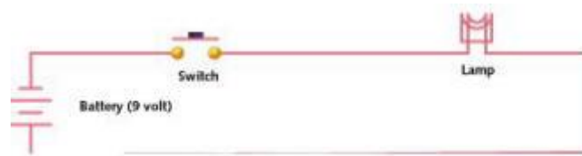
Şekil 4.11 Duty Cycle Elektriksel Devresi
