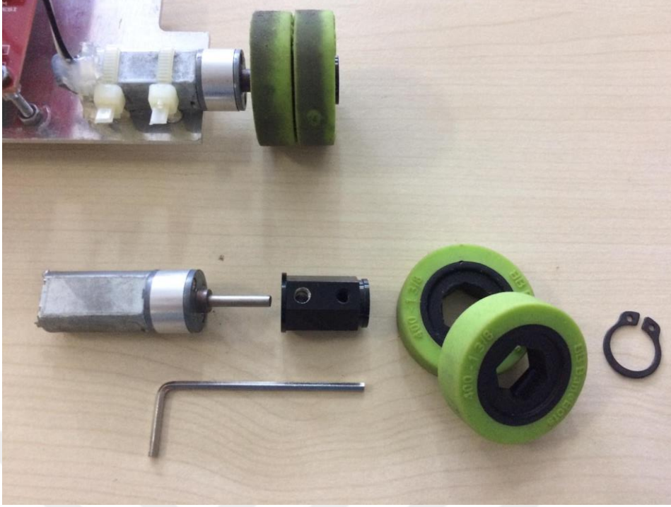
Şekil 4.48 Motor ve Tekerlek Sistemi bileşenleri ve Montajı
