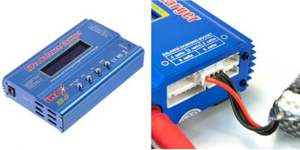
Şekil 4.25 Lipo Pil Şarj Aleti (Solda) Balance Şarj İşlemi (Sağda)
