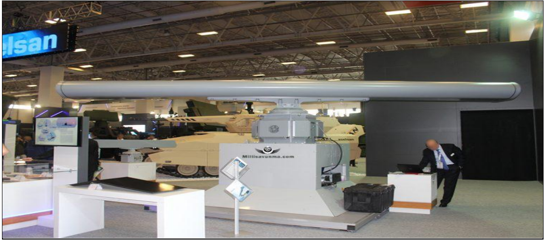
Şekil-27 ASELSAN SERDAR-7M Sahil Gözetleme Radarı 327
