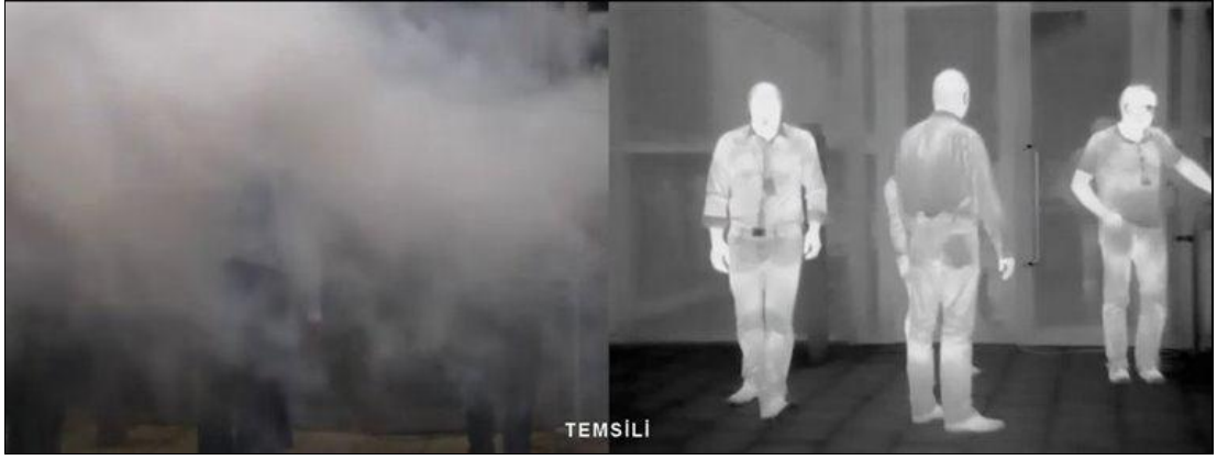
Şekil-9 Göz SW- Kısa Dalgaboyu Kızılötesi Kamera 290
