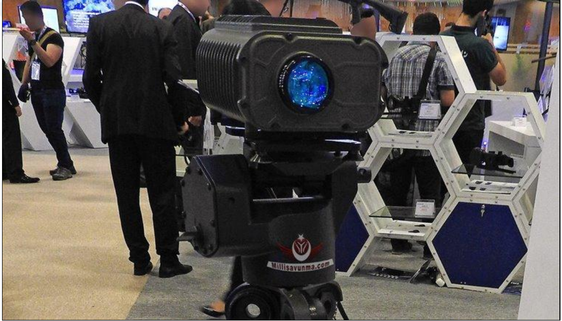
Şekil-8 Göz SW- Kısa Dalgaboyu Kızılötesi Kamera 289
