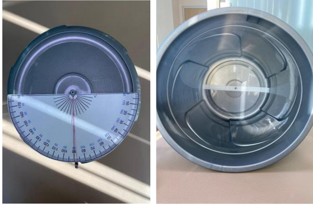
Şekil 13. SVV ve SVH kova testi
