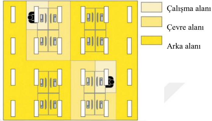
Şekil 20. Örnek bir ofis alanında tavandaki yapay aydınlatma düzeni, çalışma alanı, yakın çevre ve arka plan alanlarındaki farklı parlaklık seviyeleri (dimming), (Christel, 2019)
