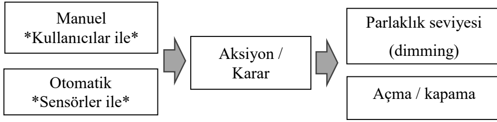
Şekil 16. Aydınlatma kontrol sistemi (Yazar tarafından oluşturulmuştur)
