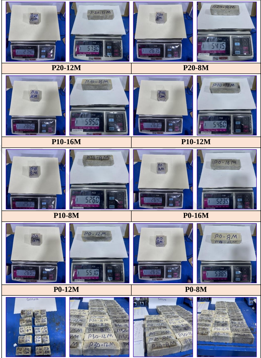
Şekil 3.10. 600°C sıcaklık maruz bırakıldıktan sonra numunelerin ağırlıkları
