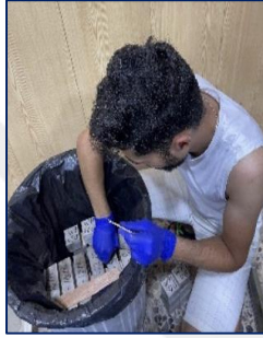
b) Numunelerin Sülfürik Asit ve Magnezum Sülfat Çözeltilerinde Bırakılması
