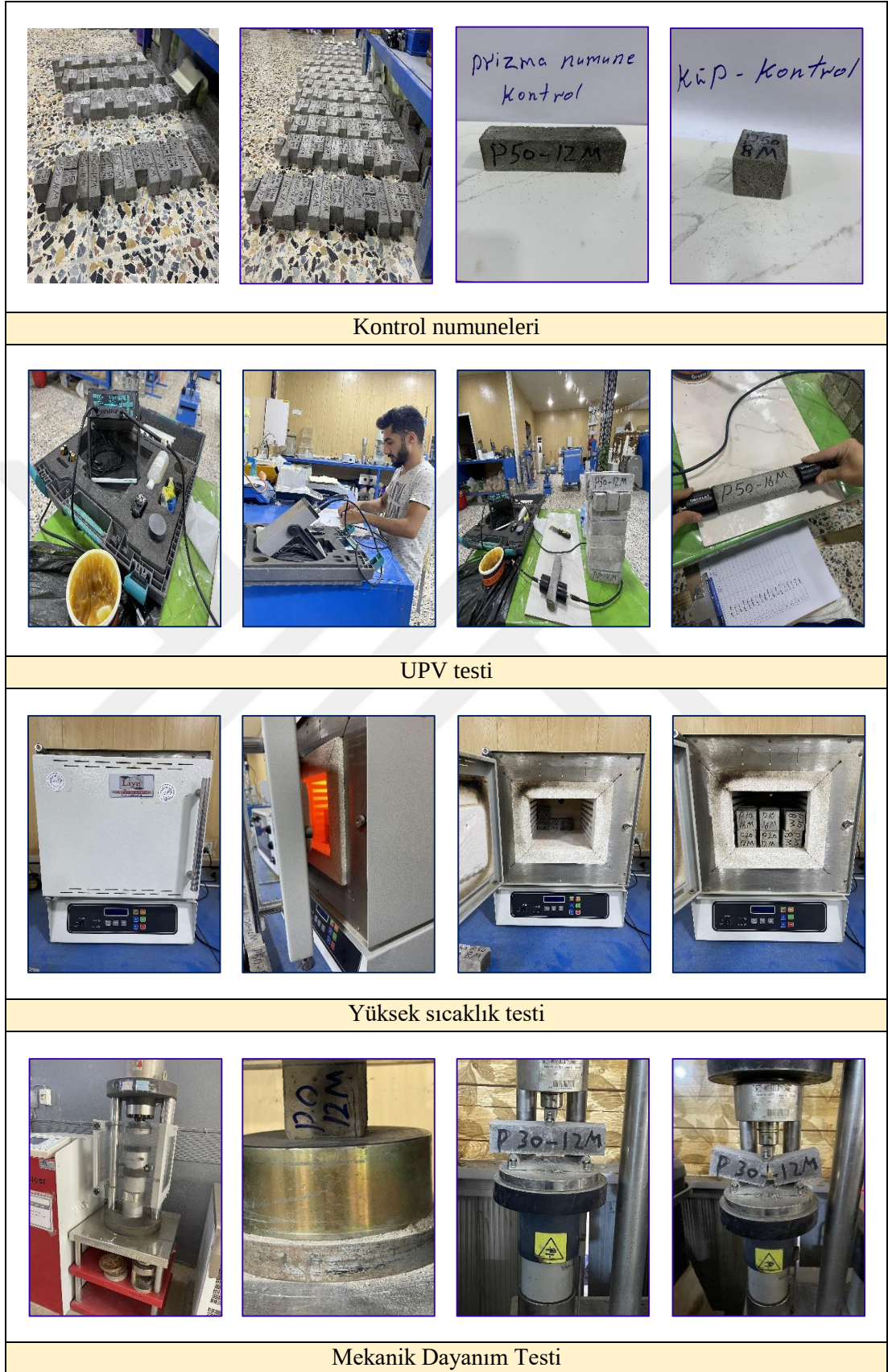
Şekil 2.3. Numunelerde UPV testi, yüksek sıcaklık uygulaması ve mekanik dayanımları
