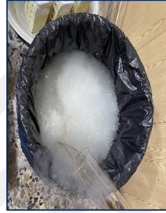
b) Numunelerin Sülfürik Asit ve Magnezum Sülfat Çözeltilerinde Bırakılması
