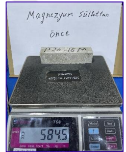
c) Numunelerin Asit ve Magnezum Sülfat Çözeltilerinde Bırakılmasından Ağırlık Ölçesi
