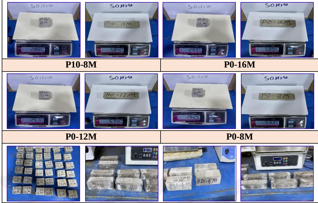
Şekil 3.8. 200°C sıcaklık maruz bırakıldıktan sonra numunelerin ağırlıkları
