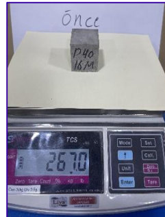
d) Numunelerin Yüksek Sıcaklığa Maruz Bırakılmadan Önce Ağırlıkları
