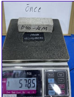
d) Numunelerin Yüksek Sıcaklığa Maruz Bırakılmadan Önce Ağırlıkları
