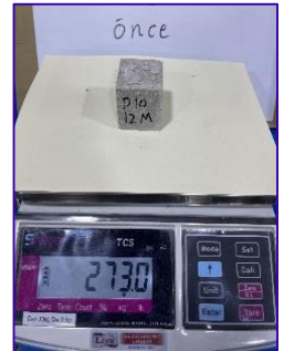
d) Numunelerin Yüksek Sıcaklığa Maruz Bırakılmadan Önce Ağırlıkları
