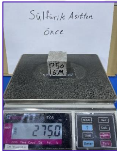
c) Numunelerin Asit ve Magnezum Sülfat Çözeltilerinde Bırakılmasından Ağırlık Ölçesi
