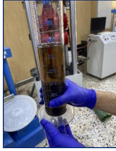
a) Sülfürik asit ve magnezum sülfat çözeltilerinin hazırlanması
