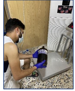
a) Sülfürik asit ve magnezum sülfat çözeltilerinin hazırlanması
