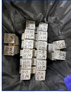
b) Numunelerin Sülfürik Asit ve Magnezum Sülfat Çözeltilerinde Bırakılması
