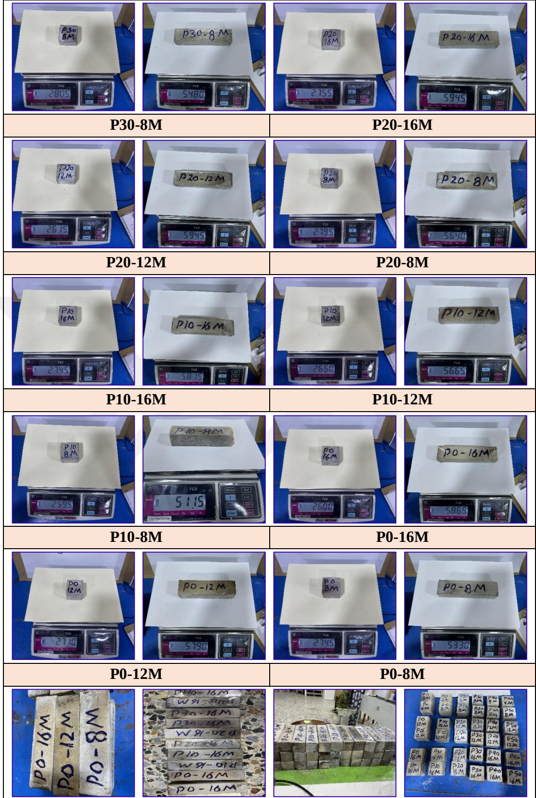
Şekil 3.9. 400°C sıcaklık maruz bırakıldıktan sonra numunelerin ağırlıkları
