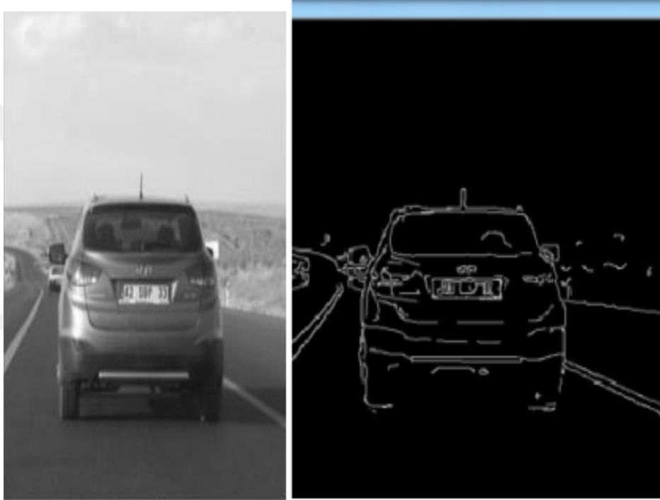
Şekil 13. (a) Normal görüntü (b) Canny filtresi uygulanmış görüntü
