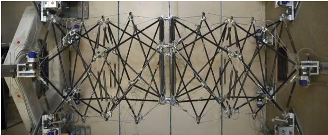
Şekil 47. Konuşlandırılabilir germedenge yaya köprüsünün küçültülmüş ölçekli modeli Kaynak: Micheletti A ve Podio-Guidugli P, (2022)
