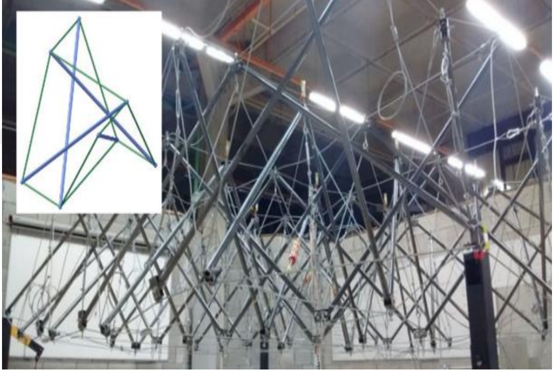
řekil 2. Gómez-Jáuregui ve dięerleri tarafından önerilen konuřlandırılabilir ızgara ve temel modülü
