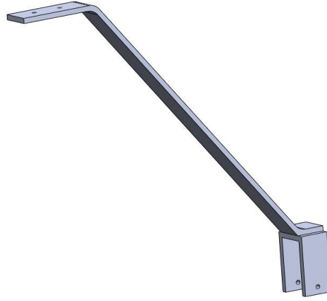
Şekil 27. Tasarlanan Hava Aracı İniş Takımı CAD Çizimi
