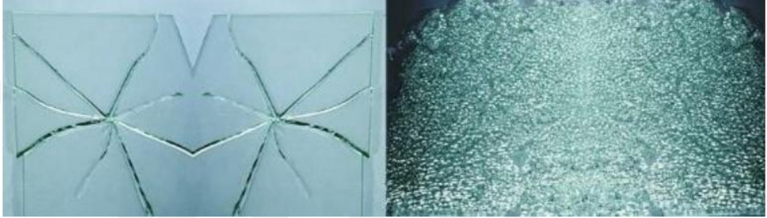
Şekil 21. Kırık Düz Cam ile Kırık Temperli Cam Örneği ("Binalarda doğru yalıtım", 2025)
