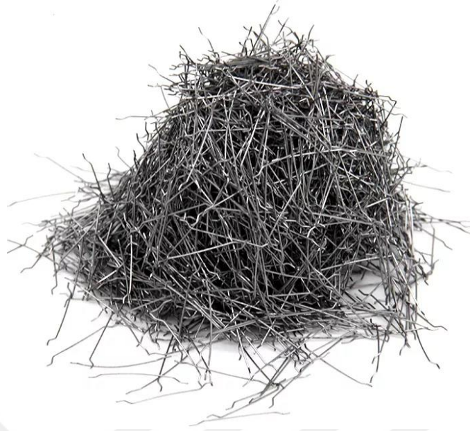
Şekil 2.4 Kancalı uçlu çelik lif
