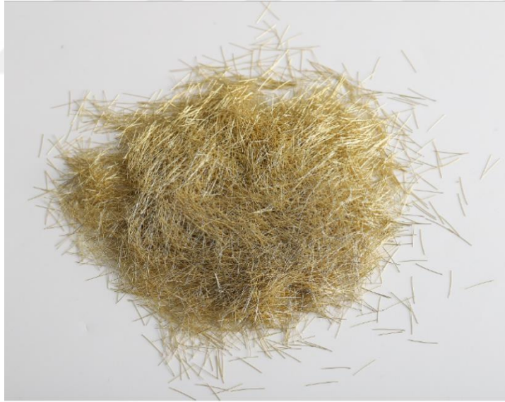
Şekil 2.3 Bakır kaplı çelik Lif
