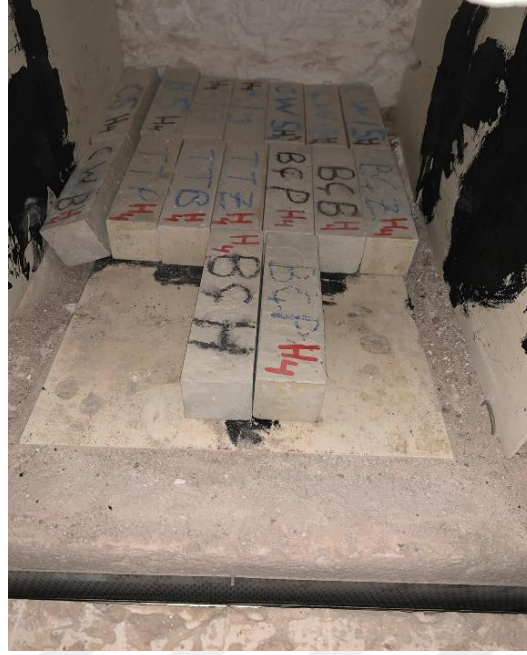
Şekil 2.8 Yüksek sıcaklık testi sonrası numuneler
