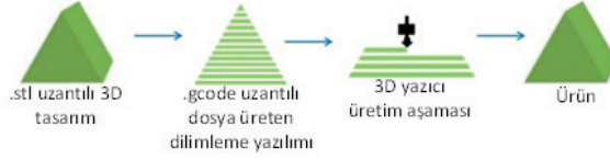
Şekil 2. 3D yazıcıda üretim aşamaları ("3D yazıcı üretim aşamaları", 2018)
