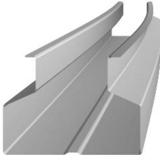
Şekil 65. 3.Bölge için statik yükler altında max boyda burkulma modu şekli
