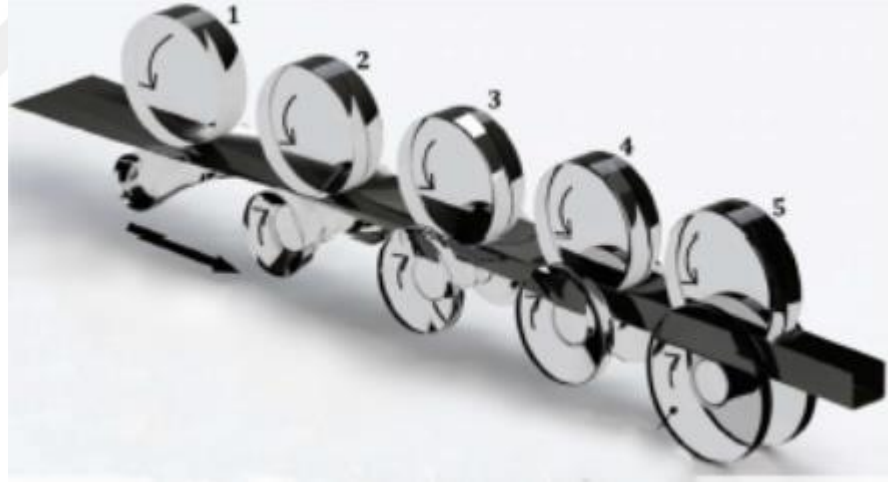
Şekil 12. Rulo şekillendirme işleminin şematik gösterimi (Abvabi 2014)
