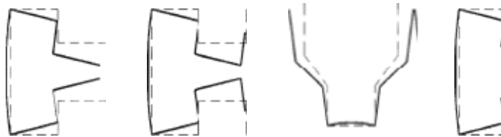
Şekil 20. Buruşma modlarına örnekler (BS EN 1993-1)
