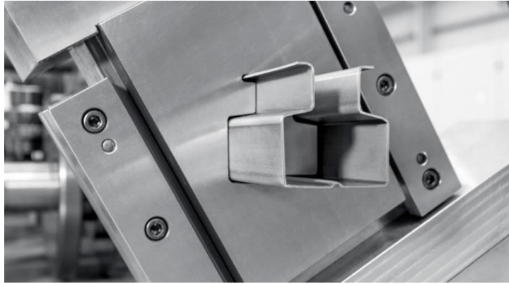
Şekil 14. Rollform makinesinde profil kesme işlemi ( www.rollform.org )
