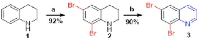
Şema 2. 6,8-Dibromo kinolinlerin 2 ve 3 sentezi. Reaktifler ve şartlar a) Br 2 (2 eq), CHCl 3 , 2 saat, 25 °C; b) DDQ (2 eq), benzen, 78 °C, 3 saat.
