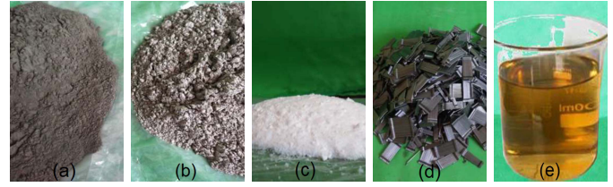
Fig. 1. Photographs of (a) GGBFS, (b) NS, (c) SP, (d) SF, and (e) NaOH [33].
