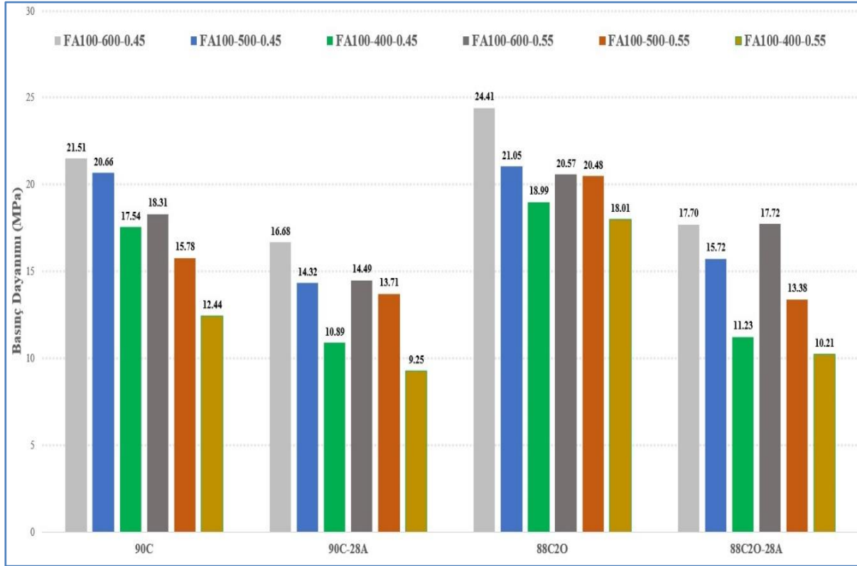
Şekil 4.14 Alkali aktivatör/bağlayıcı oranı 0.45 ve 0.55 olan numunelerinin basınç dayanımları
