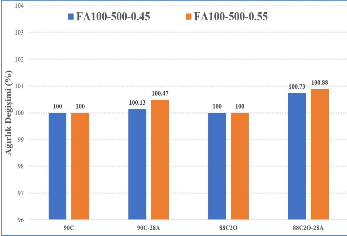
Şekil 4.3 FA100-500 numunelerinin ağırlık değişimi sonuçları
