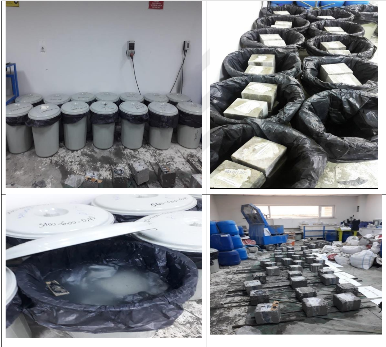
Şekil 3.8. Numunelerin sülfürik asit solüsyonunda bekletilmesi
