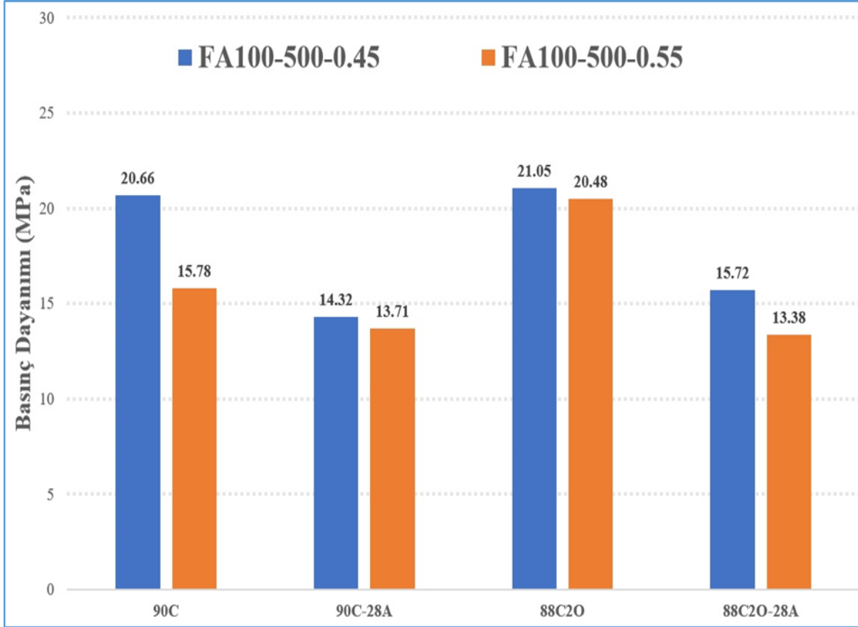
Şekil 4.10 FA100-500 numunelerinin basınç dayanımı sonuçları
