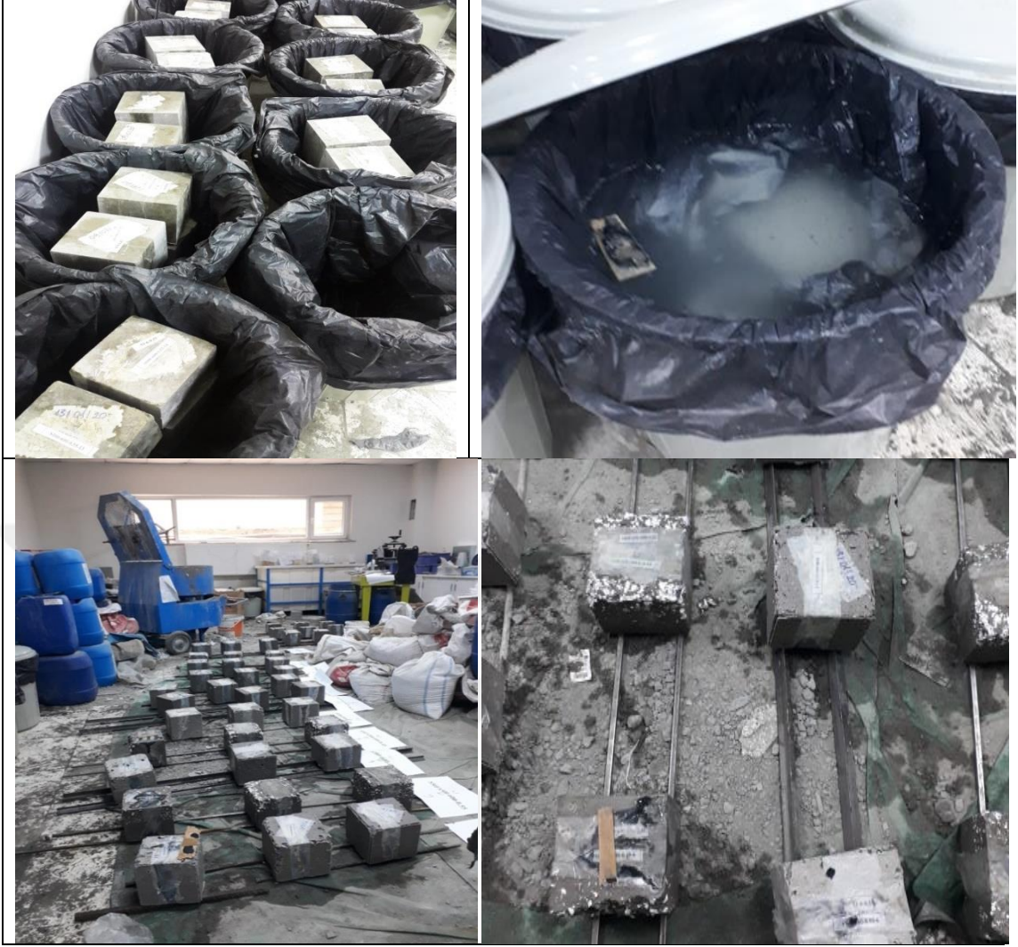
Şekil 3.9. Beton numunelerinin %5 sülfürik asit çözeltilerinde bekletilmesi ve çıkarılması
