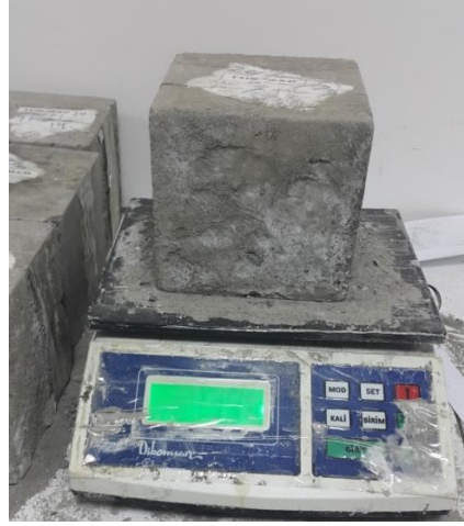
Şekil 3.10. Geopolimer beton numunelerinin ağırlıklarının ölçülmesi
