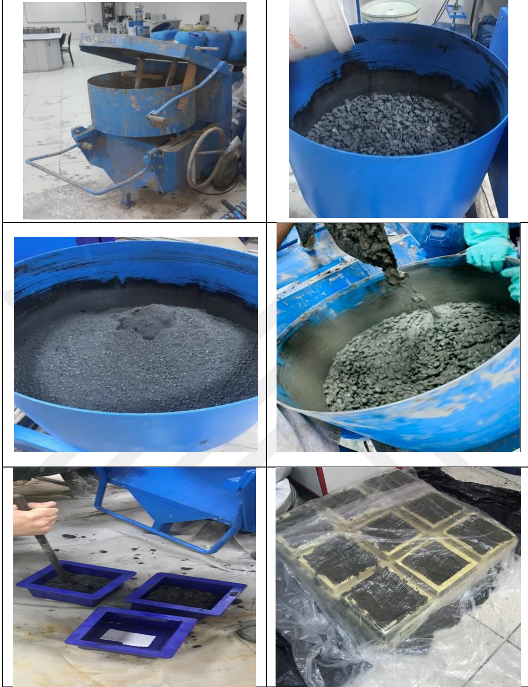
Şekil 3.8. Beton döküm aşamaları
