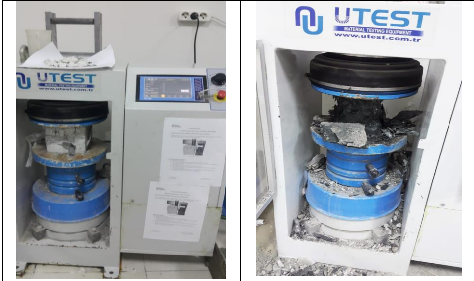
Şekil 3.11. Beton numunelerinin basınç dayanımlarının ölçülmesi
