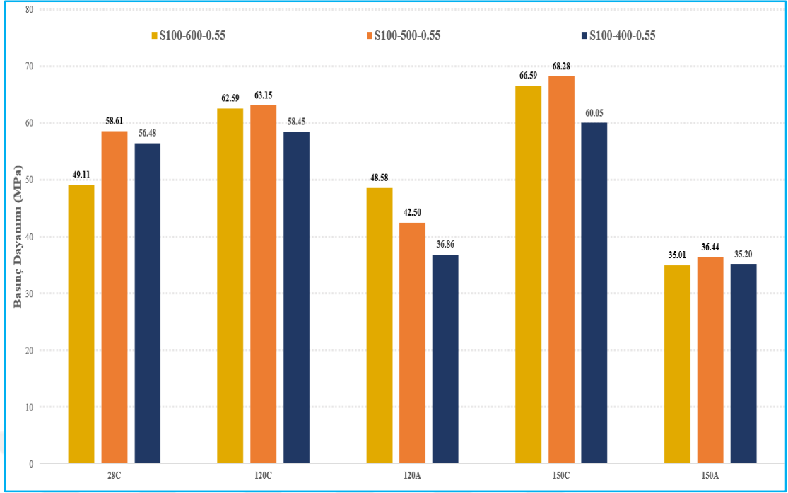
Şekil 4.14. 0.55 Alkali Solüsyon/Bağlayıcılı Alkali Aktive Edilmiş Betonların Basınç Dayanımı
