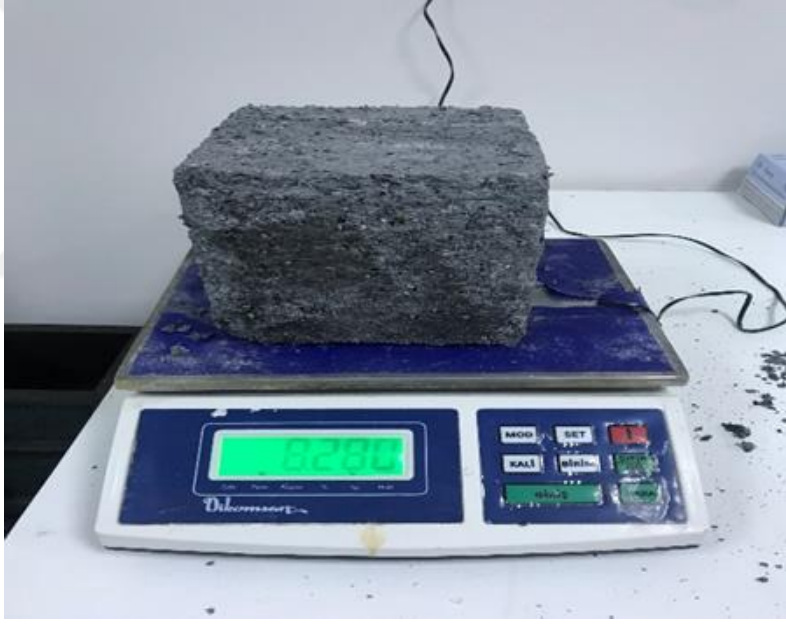
Şekil 3.8. Sülfürik Asitte Bırakılan Numune Ağırlıklarının Ölçümü
