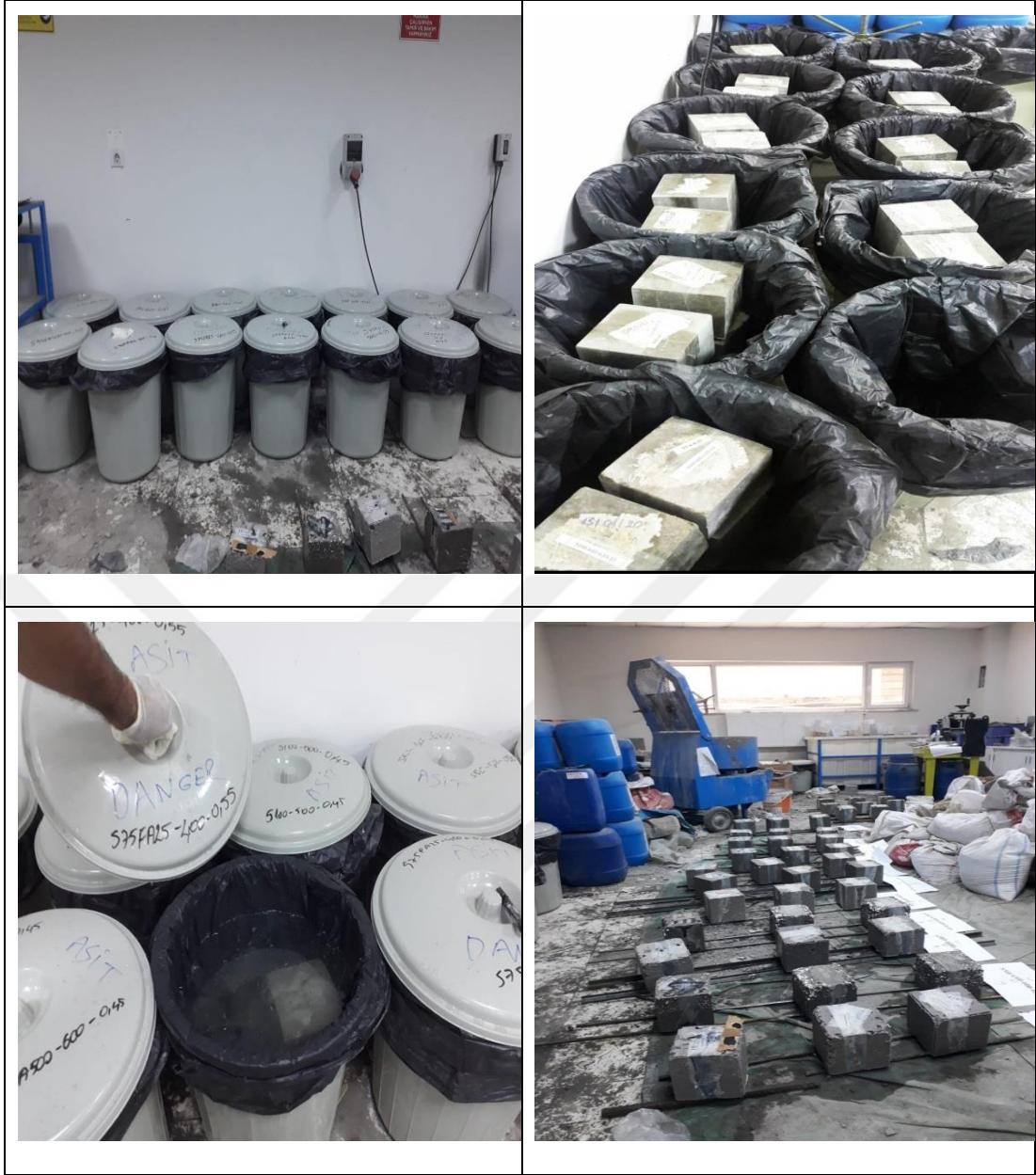
Şekil 3.7. Betonların %5 Sülfürik Asit Çözeltilerinde Bekletilmesi ve Çıkarılması
