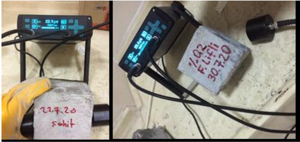
Şekil 5. Ultrases hızı ölçüm testinin yapılması
