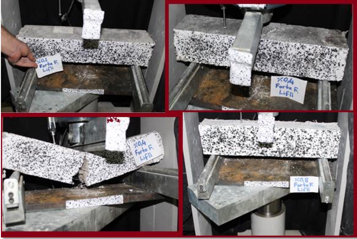
Şekil 10. Kirişlerin düzeneğe yerleştirilmesi ve kırılma durumları
