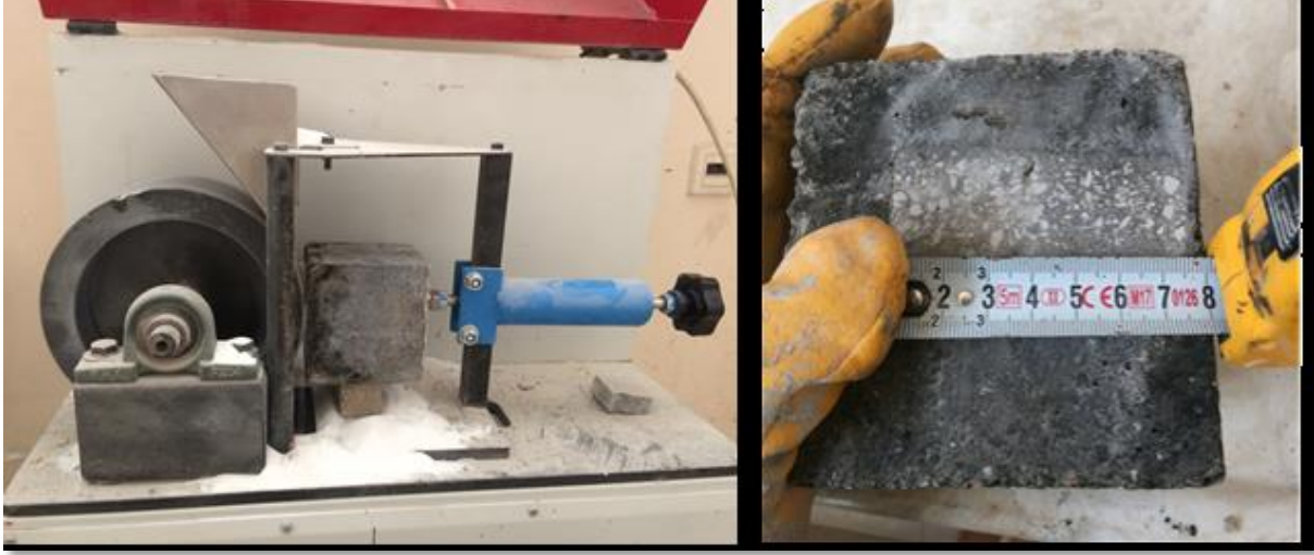
Şekil 6. Aşınma deney aleti ve aşınma miktarının ölçülmesi
