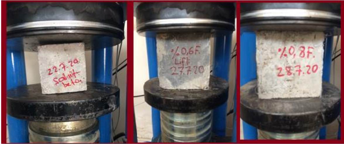
Şekil 8. Beton basınç dayanımlarının elde edilmesi
