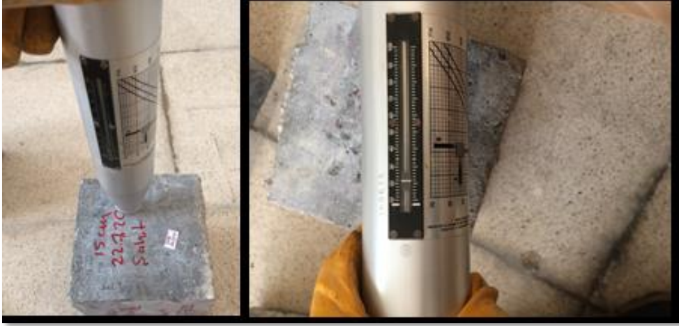
Şekil 7. Beton test çekici deneyinin uygulanması
