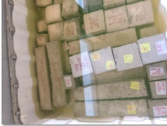
Şekil 4. Numunelerin kür havuzuna bırakılması
