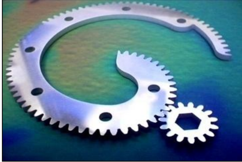
Şekil E1.ASJ ile Elde Edilen Hassas Parça Örnekleri
