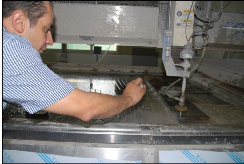
Şekil A2. ASJ Tezgahında Kesim İşlemi (G.Kore, 2009)
