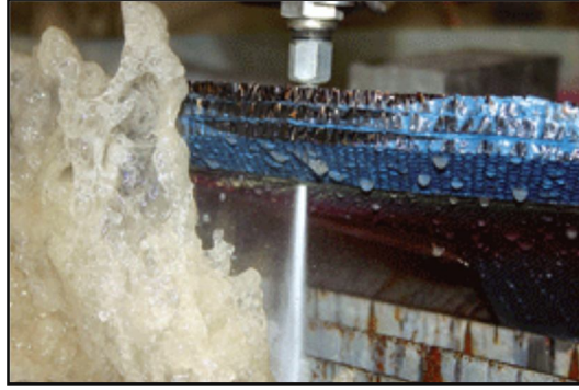
Şekil 3.1. Havacılık ve uzay sanayiinde kullanılan bal peteği malzemenin işlenmesi(www.waterjets.org, 2011)
