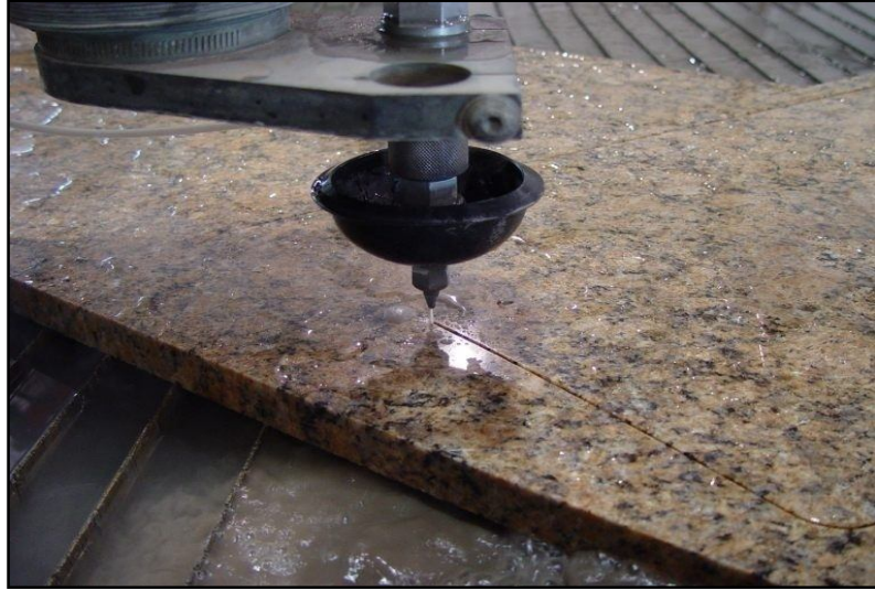
Şekil B2. ASJ ile Granit Malzeme Kesimi
