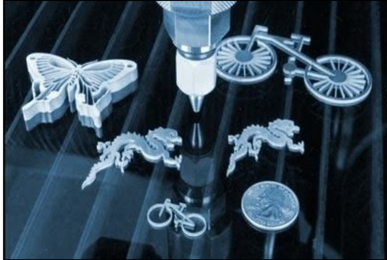
Şekil C1. ASJ ile Elde Edilen Parça Örnekleri
