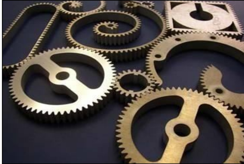
Şekil E2.ASJ ile Elde Edilen Hassas Parça Örnekleri
