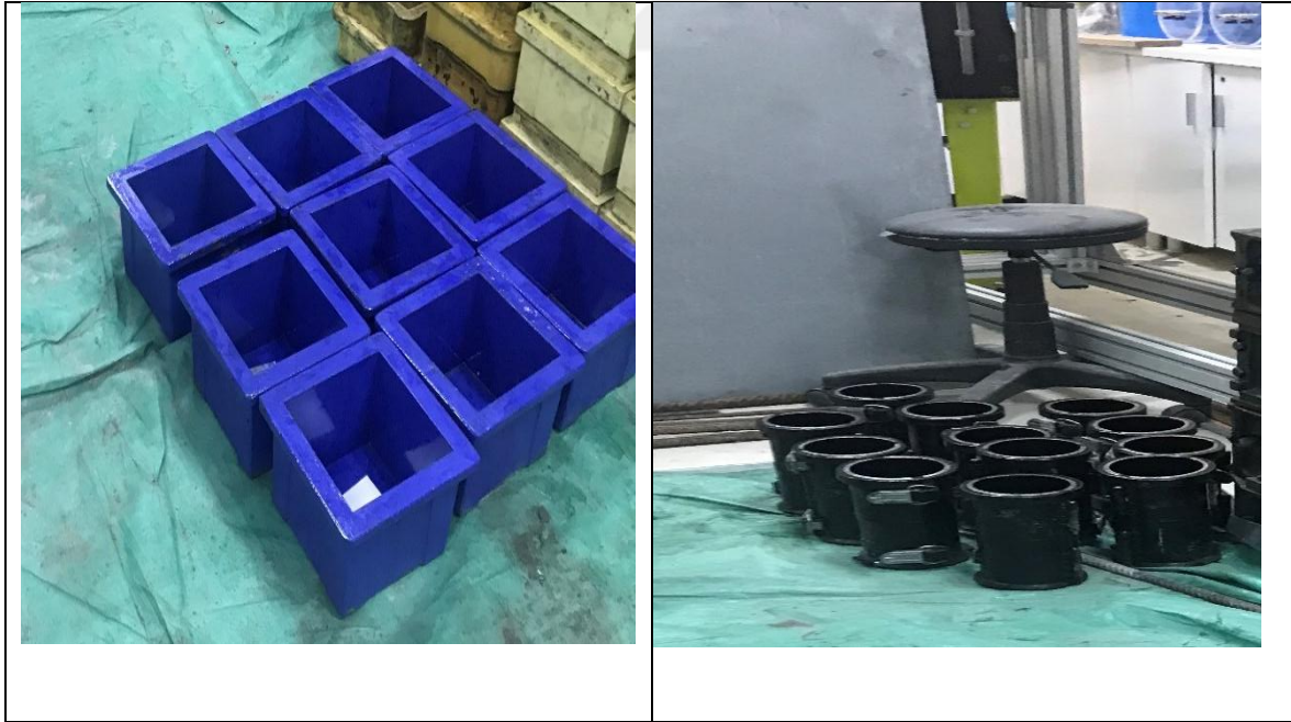
Şekil 3.4 Kalıp çeşitleri; deneyde kullanılan küp ve silindir kalıplar
