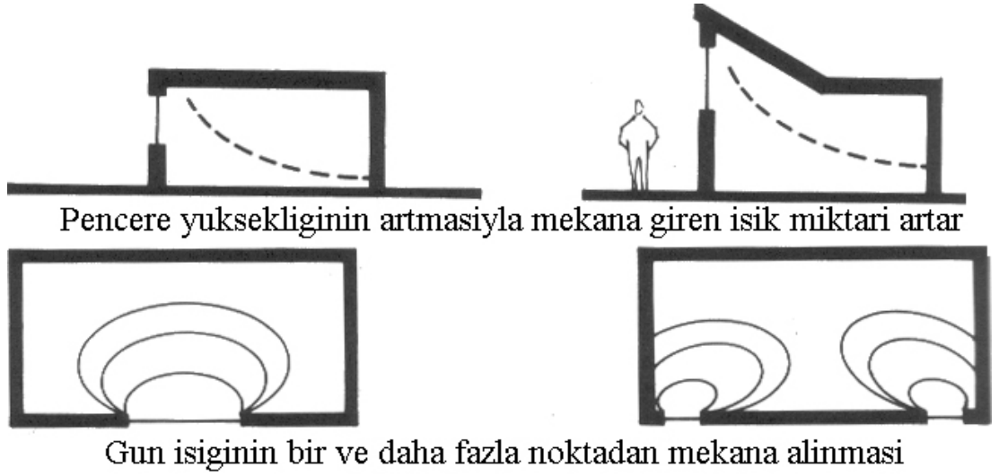
Şekil- 4 Gün Işığının Mekâna Alınmasında Pencere Yükseklik ve Konumlarının Etkileri 54
