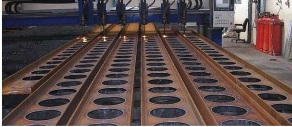
Şekil 3. Profil gövdesinde boşluk açma süreci
