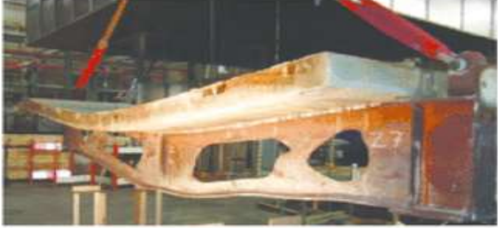
Şekil 14. Tek açıklıklı kirişte Vierendeel mekanizmasının oluşumu
