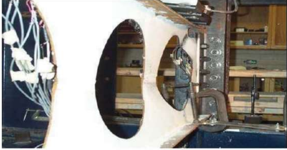
Şekil 18. Gövdede burkulma sonrası davranış
