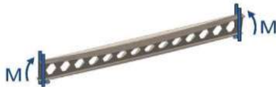
Şekil 30. Bir eğilme momenti ile yüklenen petek bir eleman yanal ve burulma olarak göçmesi
