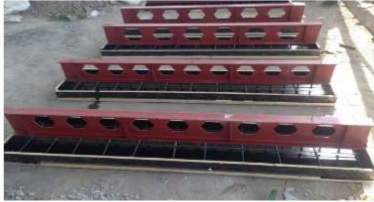
Şekil 33. Numunelerin hazırlanması için beton dökümü
