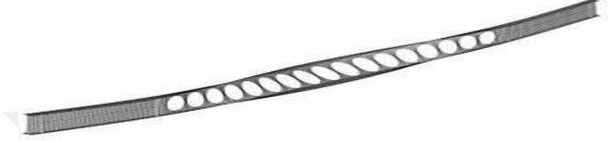
Şekil 17. Bir petek kirişin yanal burulmalı burkulması
