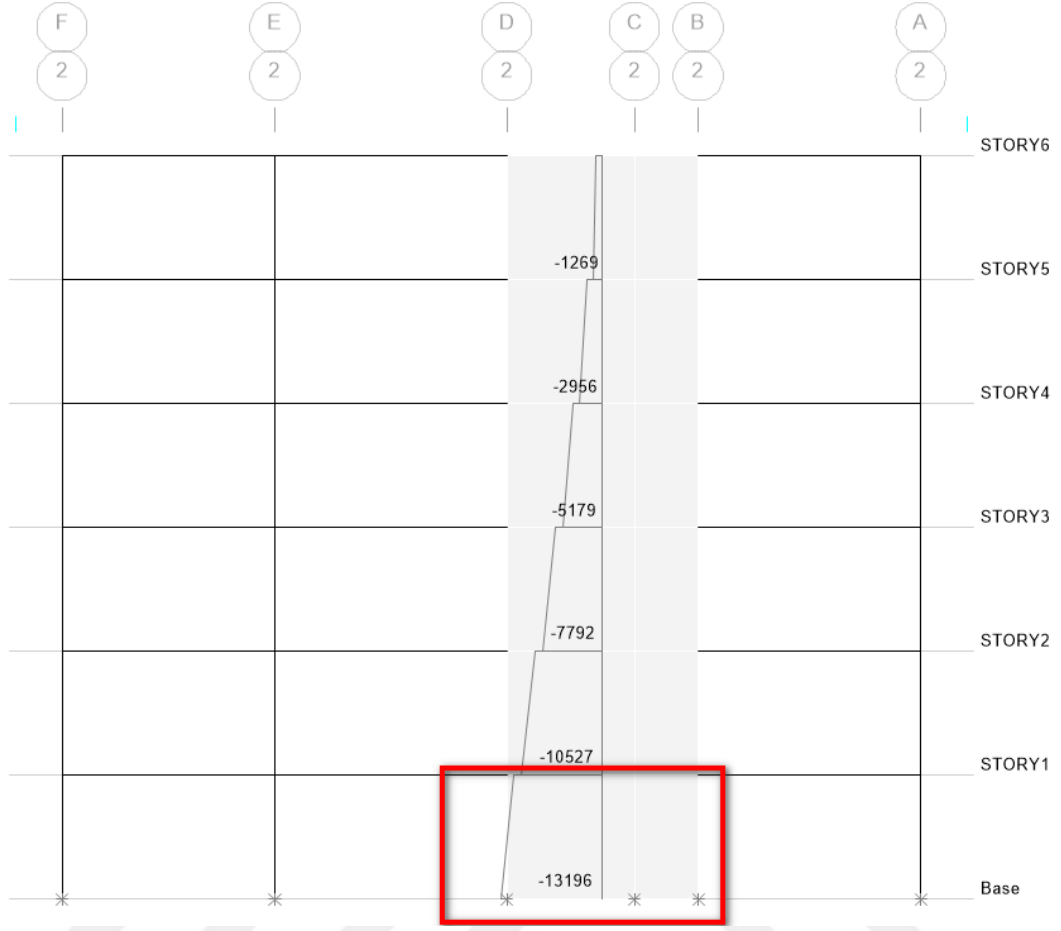
Şekil 213. P495-1 Perdesi ZE Zemin Sınıfında Düşey ve Depremlî Yükler Etkisinde Kolon Eksenel Kuvveti (kN)
