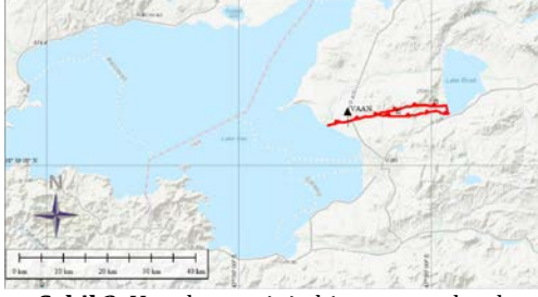
Şekil 3. Van depreminin bir sonucu olarak oluşan daha önce varlığı bilinmeyen fay (hayalet fay) kırmızı ile gösterilen ters faylanma meydana geldiği anlaşılmıştır. Yapılan literatür taramasında bu durumun arazi incelemeleriyle de uyumlu olduğu görülmüştür [1] [3].
