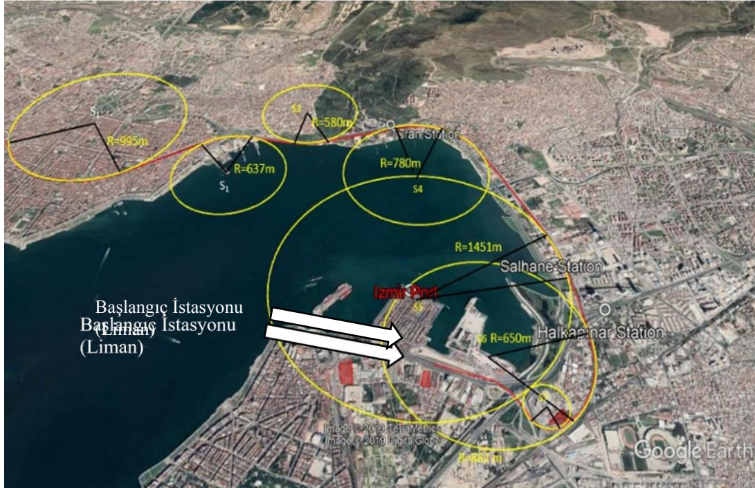
Şekil 3. Halkapınar ile Karşıyaka istasyonları arası hat için karp özellikleri [28]
