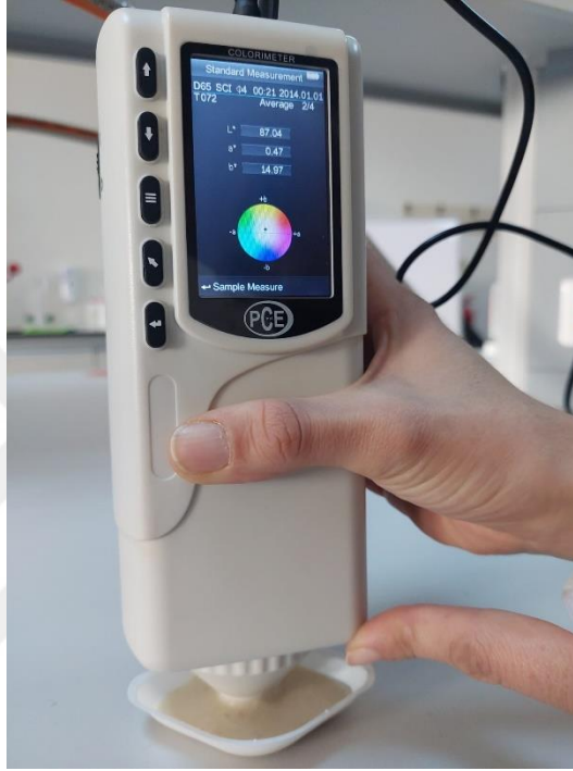
Resim 23. Kolorimetre ile köpük numunelerinin L^*,a^*,b^* değerlerinin ölçümü
