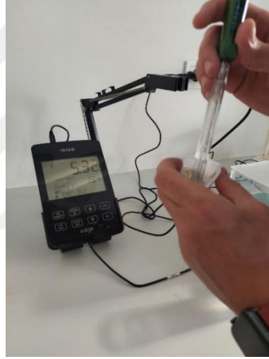
Resim 22. pH Metre ile Numunelerin Asitlik Tayini
