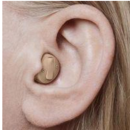
Şekil 5. Kulak içi (ITE) İşitme Cihazı (Victory, 2022)
