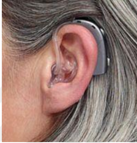
Şekil 4. Kulak Arkası (BTE) İşitme Cihazı (Victory, 2022).
