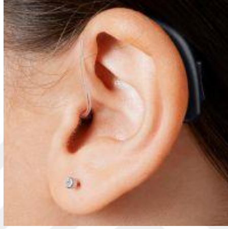
Őekil 7. Kulak İi Alıcı (RITE) İřitme Cihazı (Victory, 2022).
