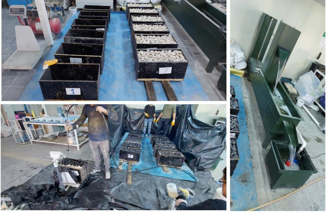
Şekil 23. Drenaj deneyi için numune kutuların hazırlanması ve deneyin başlaması
