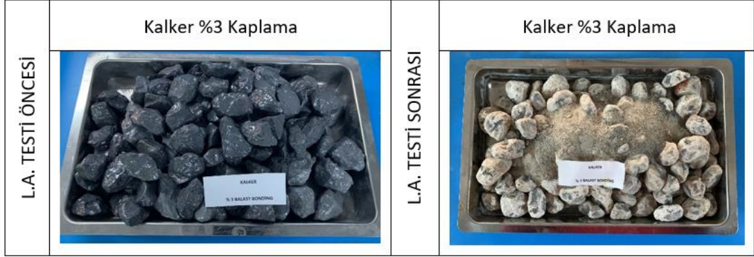
Şekil 15. Kalker balastının %3 kaplama Los Angeles deneyi öncesi ve sonrası
