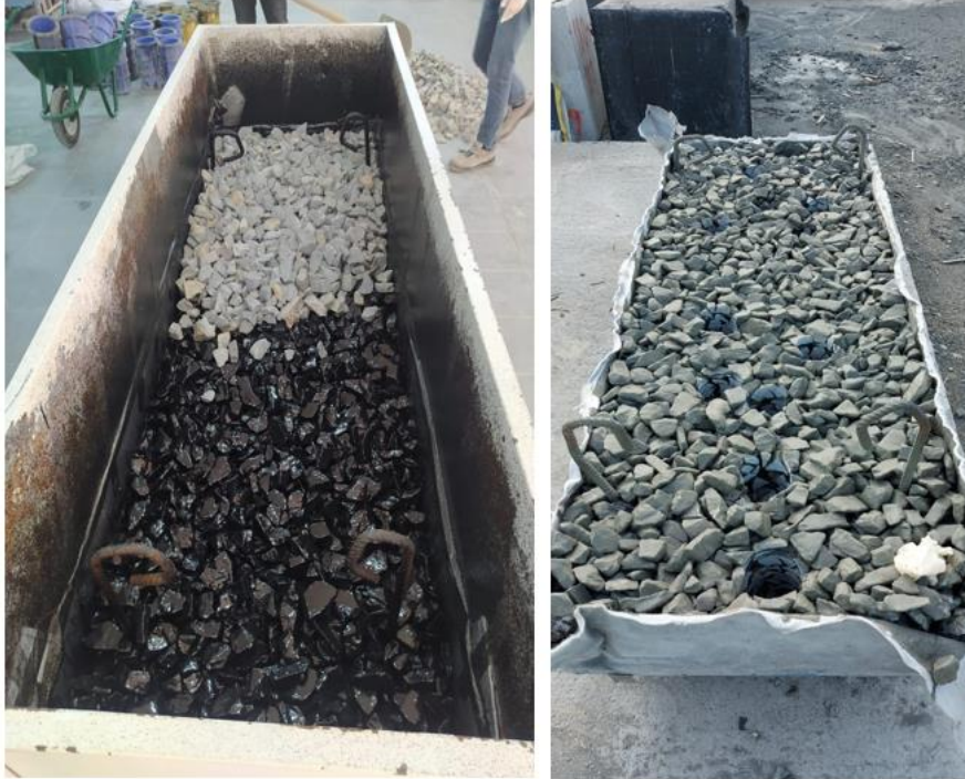
Şekil 6. Balast bağlayıcı ajan ile kaplanmış balastlar
