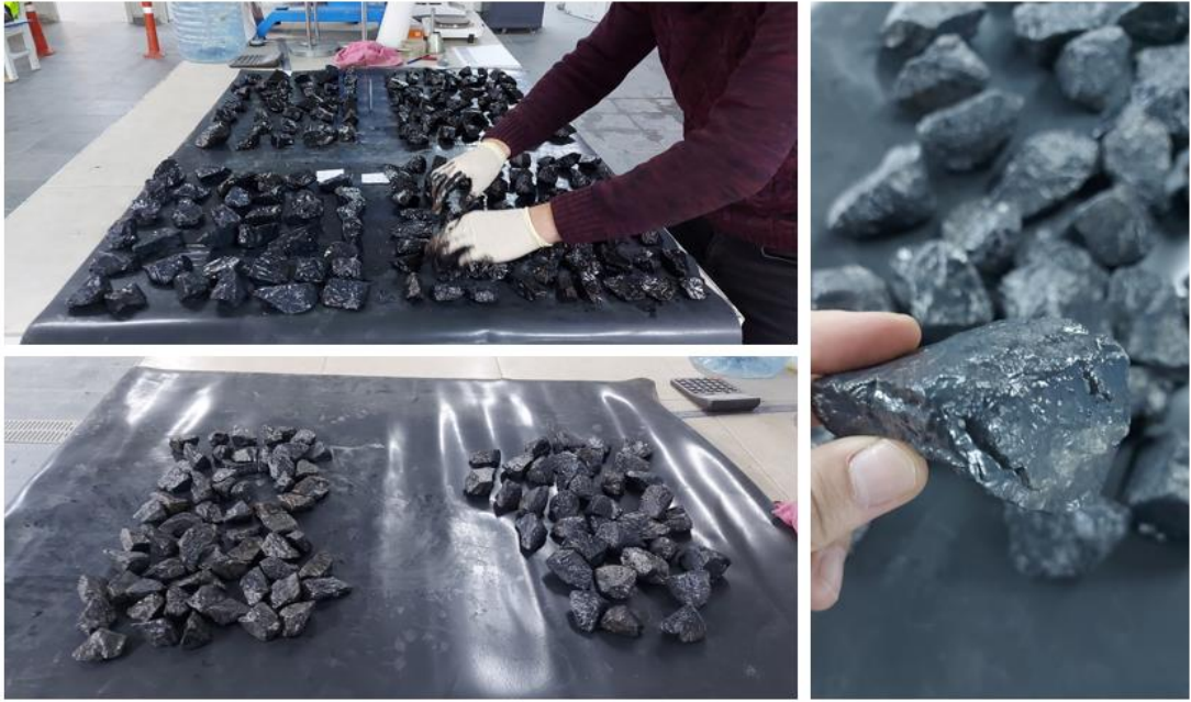
Şekil 7. Balastların kaplanma işlemleri
