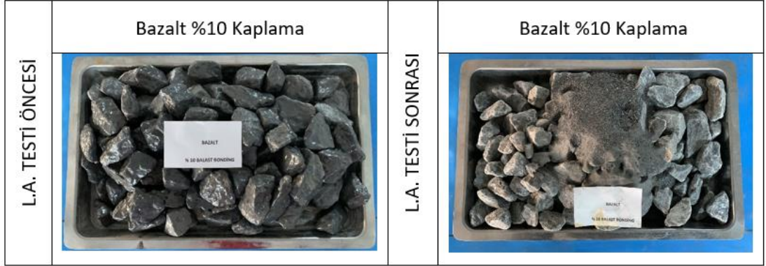
Şekil 20. Bazalt balastının %10 kaplama Los Angeles deneyi öncesi ve sonrası
