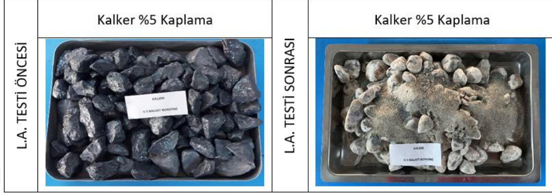
Şekil 17. Kalker balastının %5 kaplama Los Angeles deneyi öncesi ve sonrası
