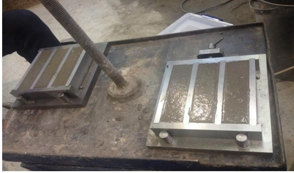
Şekil.2.13 Karışma vibratör uygulanması
